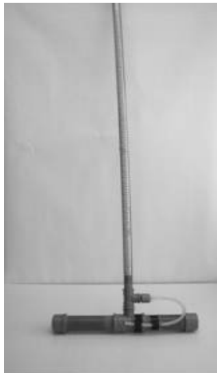
Figura 3.10. Coletor de amostras usado no interior das lagoas.
