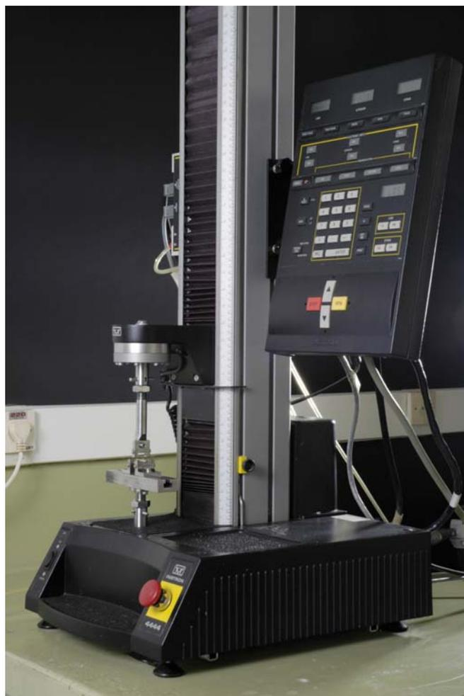
Figura 28 - Máquina de ensaio universal Instron modelo 4444 (Instron, Canton, MA, USA)
