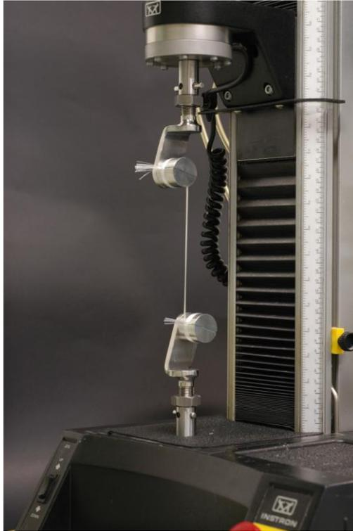
Figura 19 – Fibra de vidro em teste de tração
