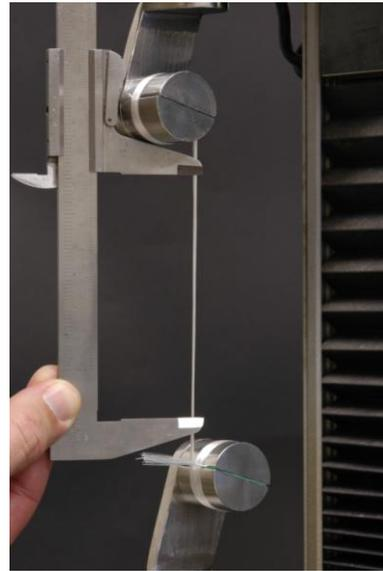
Figura 42 - Medição do alongamento com paquímetro
