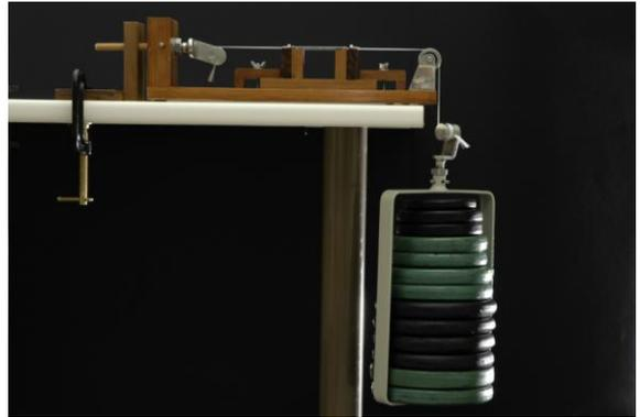
Figura 69 – Pré-tracionamento da fibra com carga de 50,65 Kg
