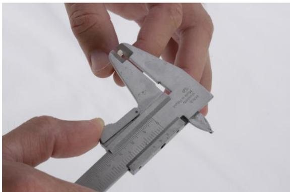
Figura 88 – Medição com paquímetro
