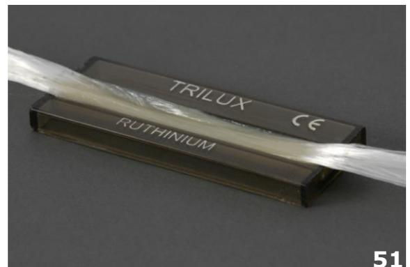
Figura 48 e 49 – Recipiente para impregnação da fibra por imersão
