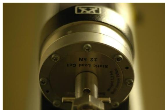
Figura 96 – Detalhe da célula de carga – capacidade de 2 KN
