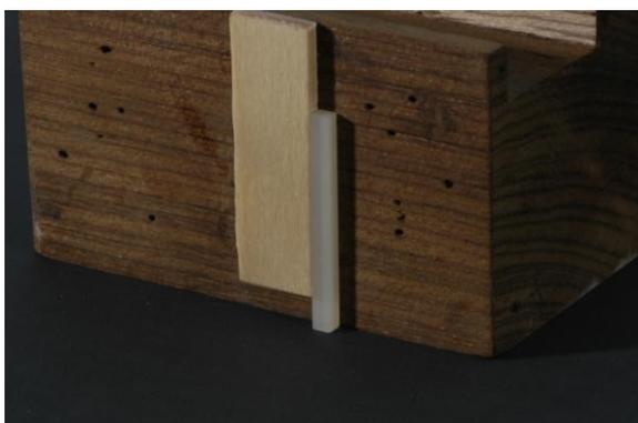
Figura 90 – Dispositivo para lixar o topo do espécime
