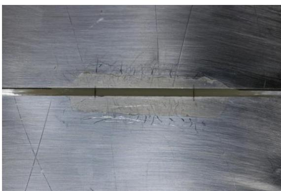
Figura 79 – Marcas no espécime antes da transferência da carga
