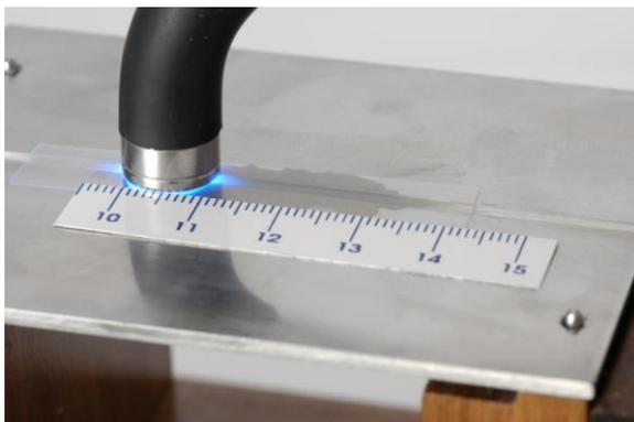
Figura 75 – Fotoativação em intervalos de 5mm
