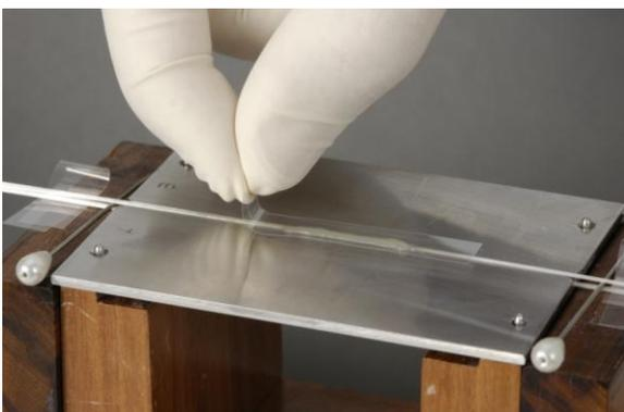
Figura 70 – Tira de poliéster sobre a resina em nítido excesso
