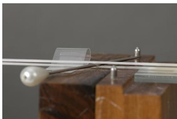
Figura 61 – Detalhe da separação de 1mm promovida pelo alfinete
