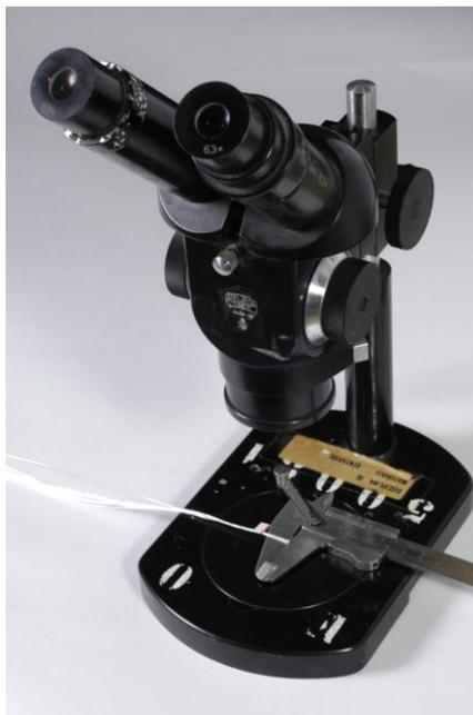
Figura 26 – Demarcação do feixe com o auxílio de um estereoscópio (25X de aumento)
