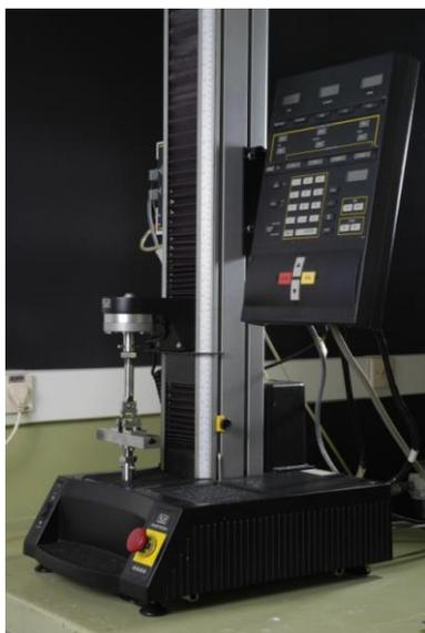
Figura 95 – Máquina de testes universal Instron 4444
