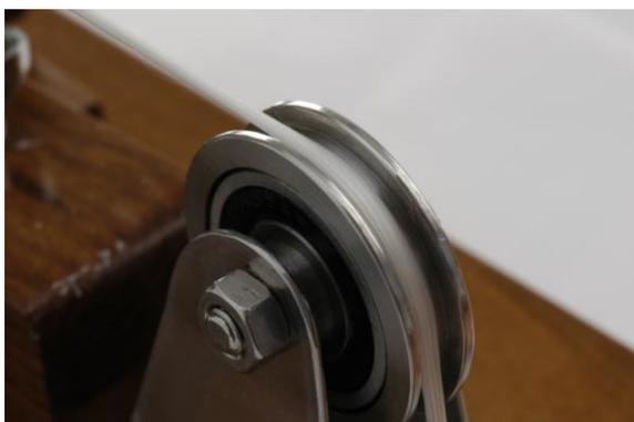
Figura 58 – Detalhe do feixe de fibra de vidro sobre a roldana
