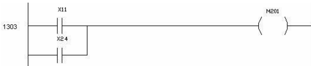
Figura 5.14. Ladder de robô em área segura e start . (Fonte: HAAS e DETTRUZ, 2004)
