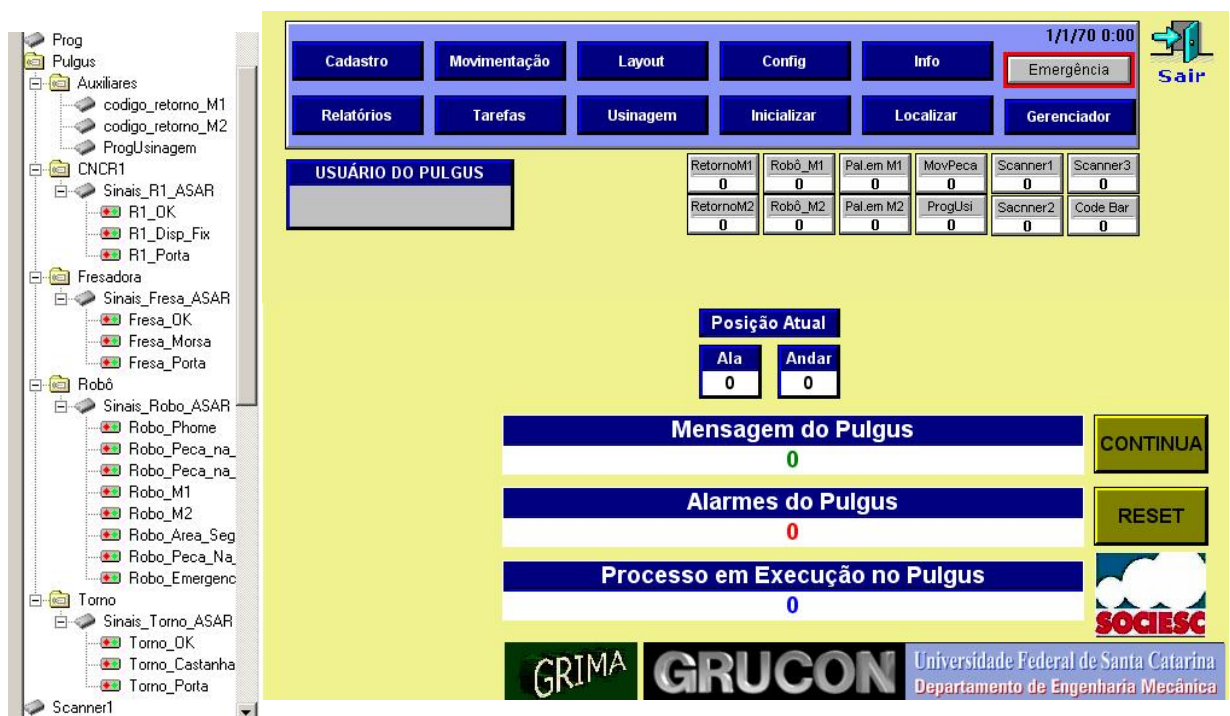
Figura 5.35. Estrutura desmembrada das tags OPC e tela principal do aplicativo.
