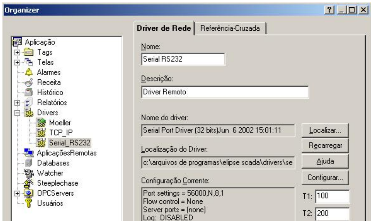
Figura 2.15. Drivers e configuração no organizer do Elipse SCADA.
