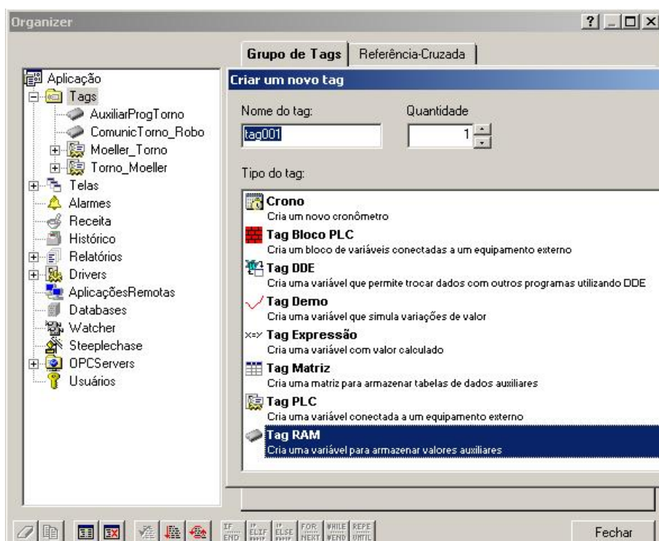
Figura 2.14. Organizer e tipos de tags do Elipse SCADA.
