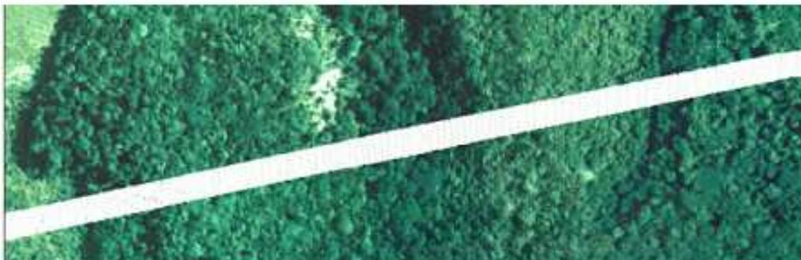
**FIGURA 4.7:** Nuvem de pontos *laser* (na cor branca) com 20 m de largura sobreposta à imagem do trecho 1
