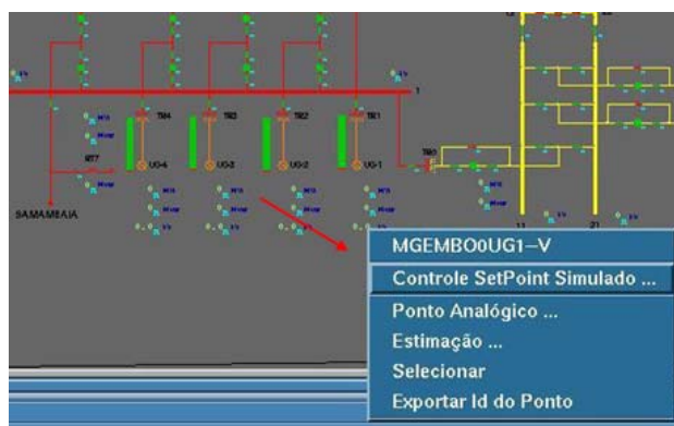
Figura 25 - Tela de comando da unidade geradora
