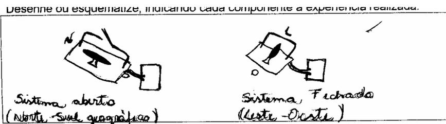
ACV: Ele pegou um fio de cobre e coloca em baixo do fio, quando ligada a agulha fica na mesma direção do fio, ou seja na direção n-s. Quando o circuito ta aberto não tem corrente, ou seja, a agulha é paralela ao fio de cobre, mas quando o circuito é fechado há corrente, ou seja, a agulha fica perpendicular ao fio. A forma é circular.
