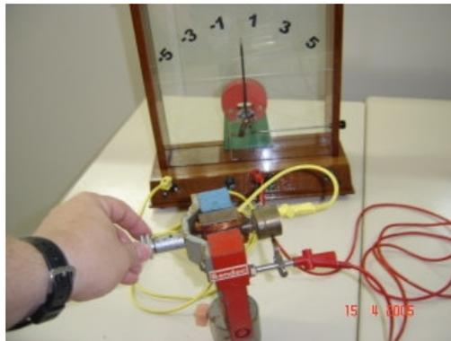
**Figura 4.9:** Gerador eletromagnético
