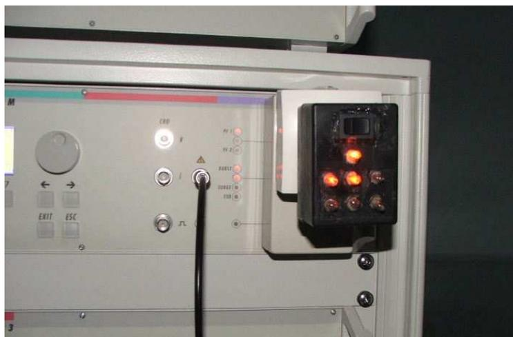
Figura 3.2.2 – Artefato sendo testado no ensaio de imunidade a *burst*.
