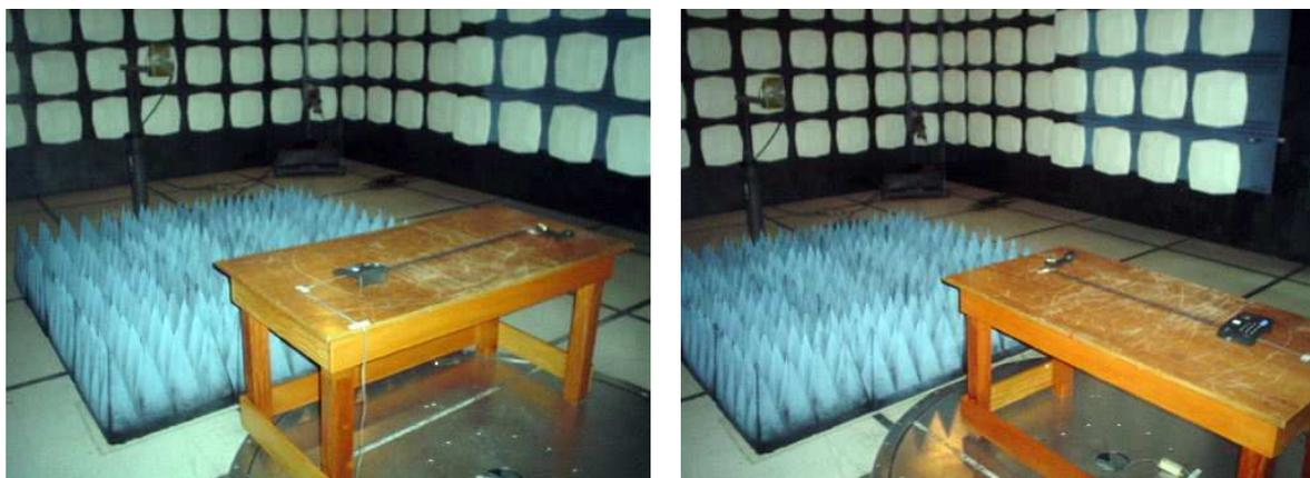
Figura 3.3.2.5 – Diferentes disposições do artefato dentro da câmara semi-aneecóica.
