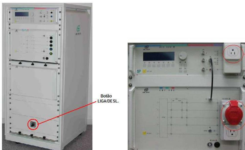
**Figura 3.4.2.1 – Simulador de transientes elétricos rápidos. Na tomada superior em destaque foi conectado o artefato.**
