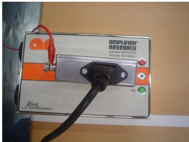
**Figura 3.1.1.2 – Gerador de ruído eletromagnético padrão NE 3000.**
