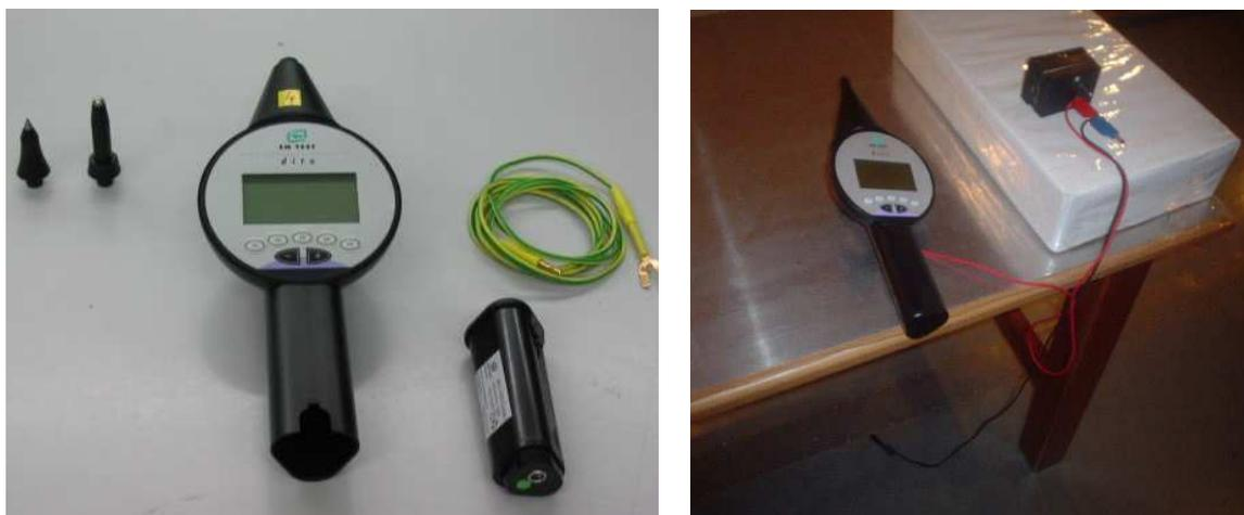
**Figura 3.2.2.1 - Pistola simuladora de descargas atmosféricas - DITO e mesma com artefato, já aterrado.**
