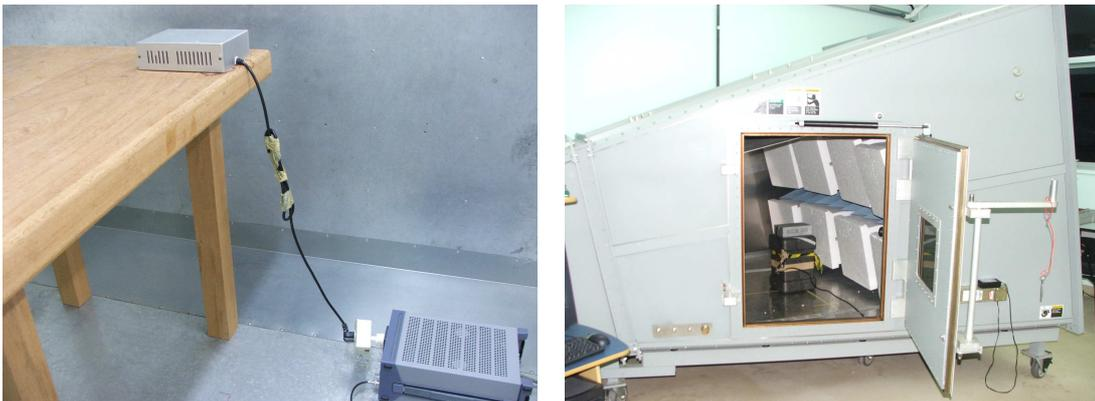
**Figura 3.1.1.1 – Fonte de alimentação nos ensaios de emissão conduzida e radiada respectivamente**
