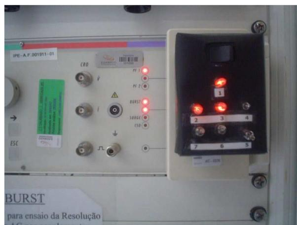
**Figura 3.4.2.3 – Ensaio de imunidade a transientes elétricos rápidos sendo aplicado no artefato.**
