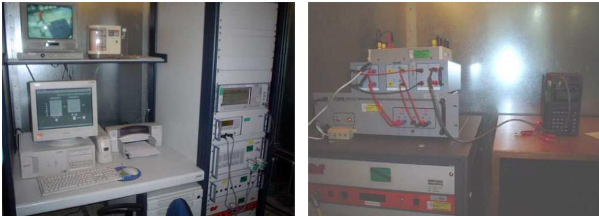
**Figura 3.3.2.4 – Equipamentos localizados fora da câmara semi-aneecóica utilizados no ensaio de imunidade radiada.**
