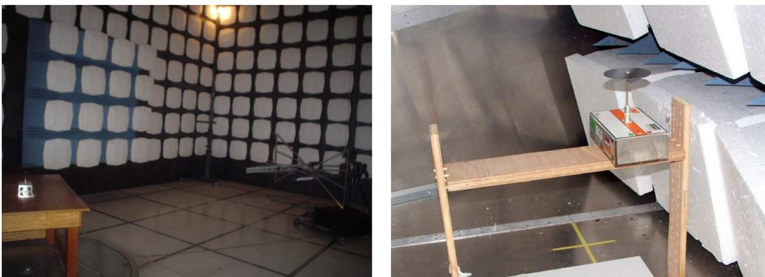
**Figura 3.1.2.1 – Configurações da medida de emissão radiada nos dois laboratórios, semi-anecóica e GTEM, respectivamente.**
