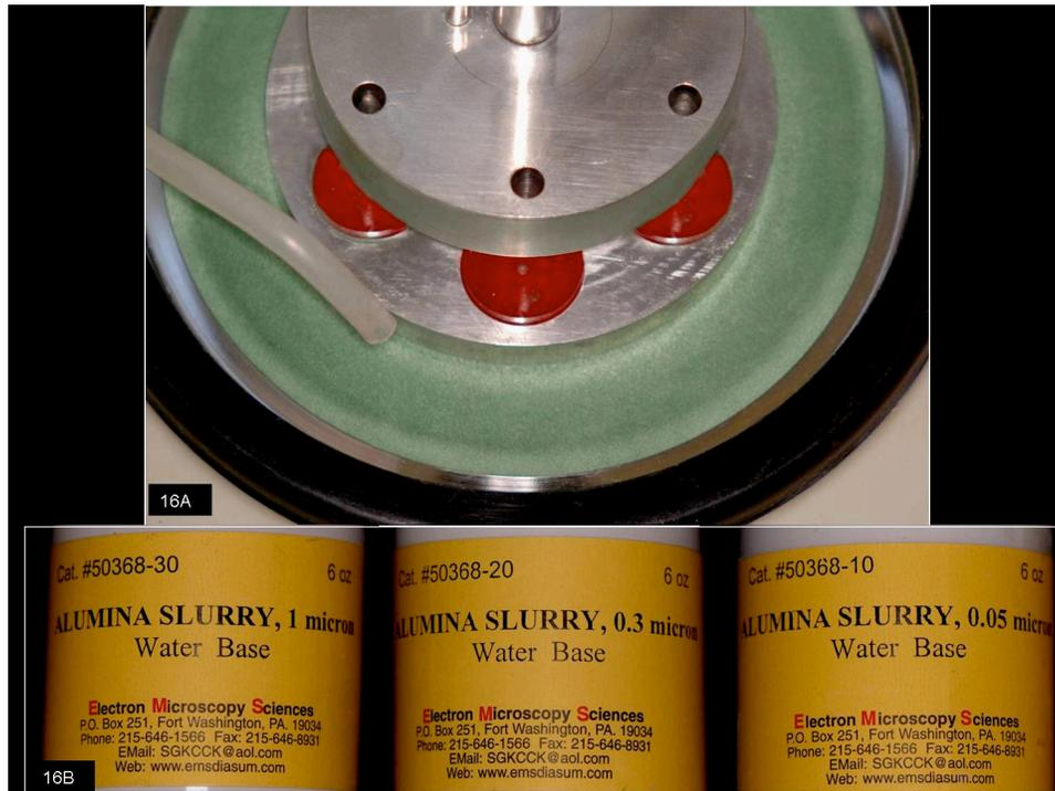
Figuras 16.a, b) detalhe do polimento simultâneo dos espécimes e das pastas utilizadas.
