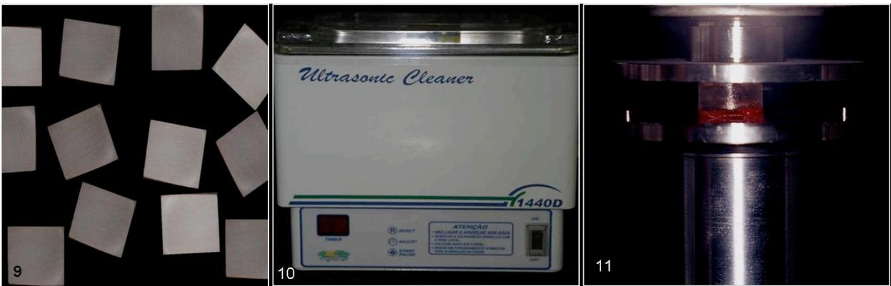
Figura 9. Alguns dos blocos de esmalte obtidos, com dimensões aproximadas de 2,5mm x 2,5mm x 1,0mm.
