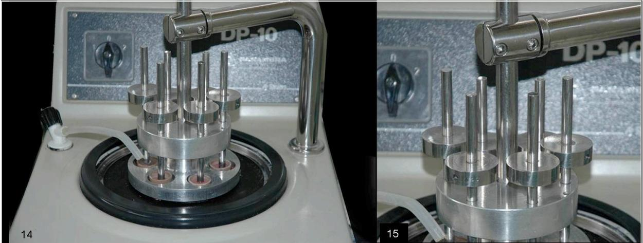
Figura 14. Máquina polidora automática com refrigeração à água (DP-10/ Panambra Struers, Dinamarca).
