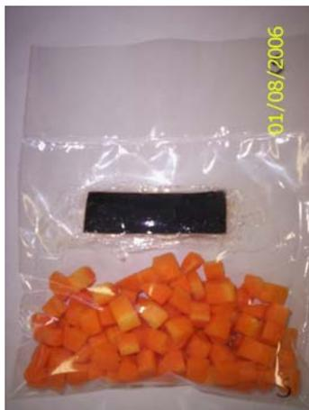
FIGURA 3: Embalagem de polietileno de baixa densidade com septo de borracha para coleta de gases.
