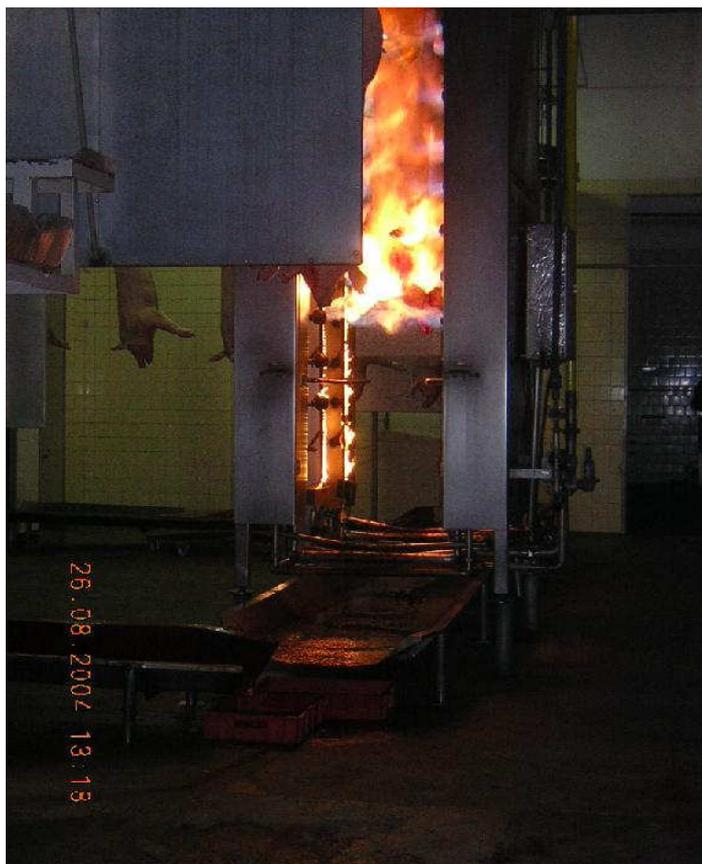
Figura 40: Chamuscador de pêlos de suínos, o calor excessivo sobre piso provoca desagregação de partículas da camada superior.
