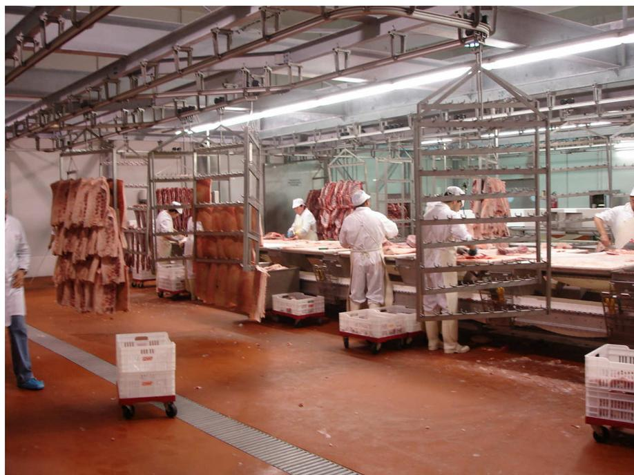
Figura 45: Processo de cortes: carnes de suínos com a queda de pedaços de carne e gorduras, provocando desgastes do piso.
