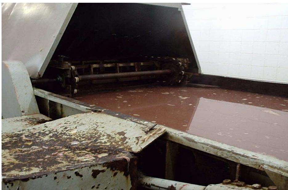
Figura 35: Tanque de escaldagem de suínos, água quente com pH 6,0 caindo sobre o piso e provocando desgastes.
