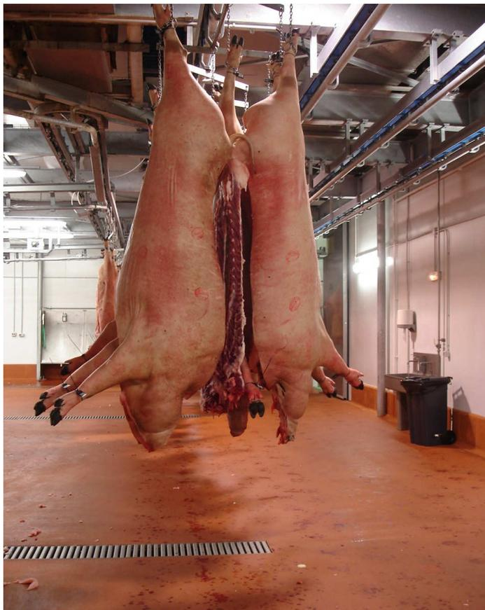
Figura 47: Transporte aéreo de carcaças para cortes, com o gotejamento de sangue, provoca desgaste do piso e a formação de buracos.
