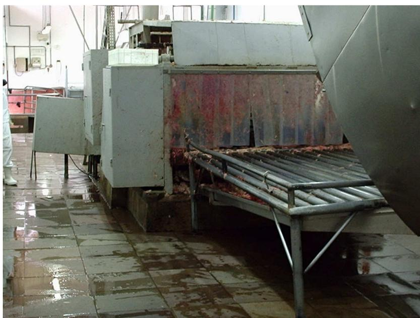
Figura 33: Mesa de sangria de suínos, com sangue caindo sobre o piso, provocando apodrecimentos, rachaduras e outros.
