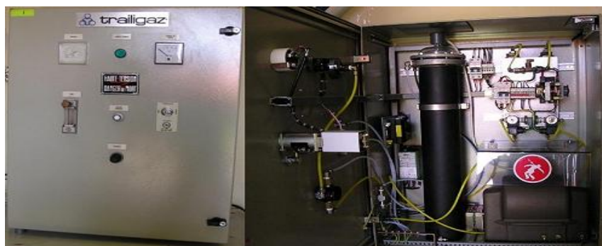
FIGURA 17 – Imagem do gerador de ozônio marca Trailgaz.
