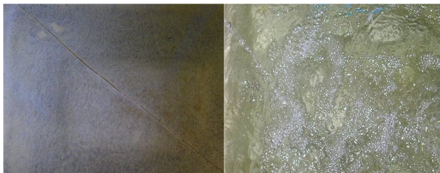
FIGURA 32 – Imagem do ar no efluente filtrado da água ozoflotada. Da esquerda para a direita: 1ª Imagem – Efluente filtrado; 2ª Imagem – Efluente filtrado sob agitação.
