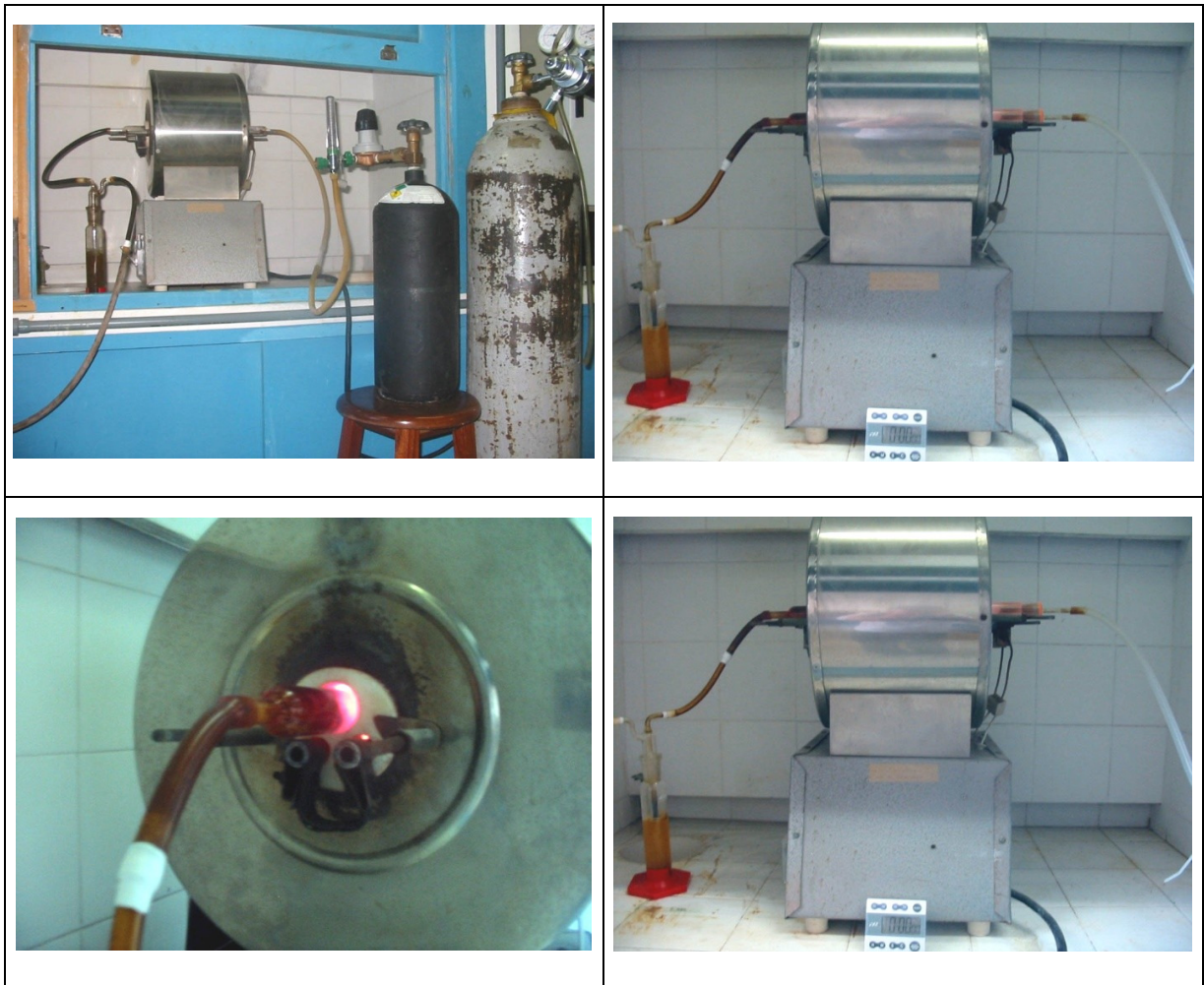
Figura 18: Processo de ativação em condições de atmosfera controlada.
