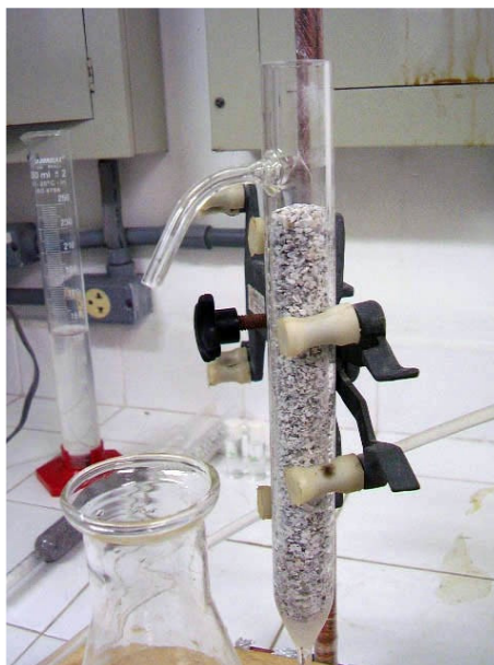
Figura 23: Coluna de vidro com alimentação em fluxo ascendente.
