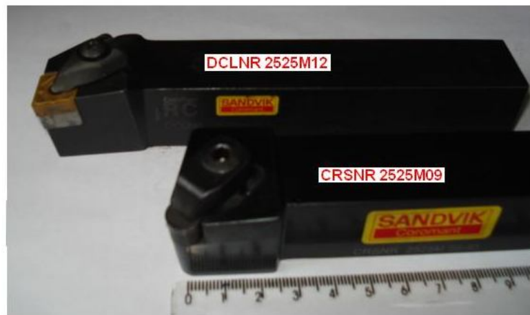
Figura 3-3 Suportes para a fixação das pastilhas de corte.
