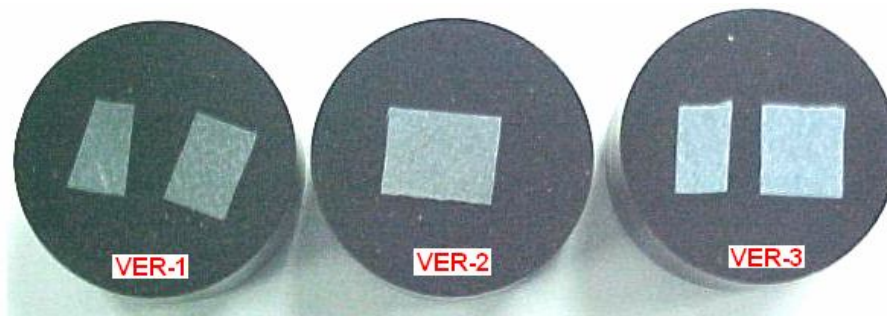
Figura 4-1 Amostras embutidas para a análise da microestrutura dos corpos de prova.
