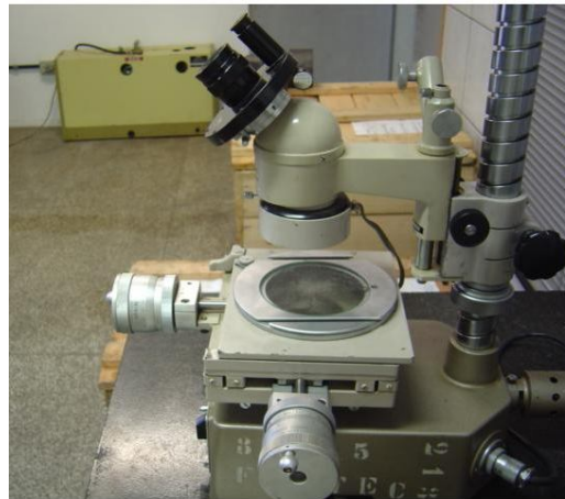
Figura 3-4 Microscópio utilizado para a medição do desgaste das ferramentas de corte.
