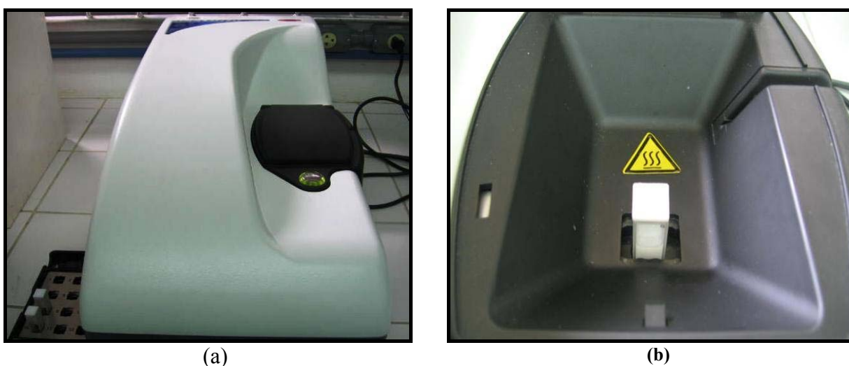
Figura 3.5 - Equipamento de medida de tamanho de partícula. a) ZETASIZER NANO S, b) Amostra de miniemulsão na cubeta de análise.
