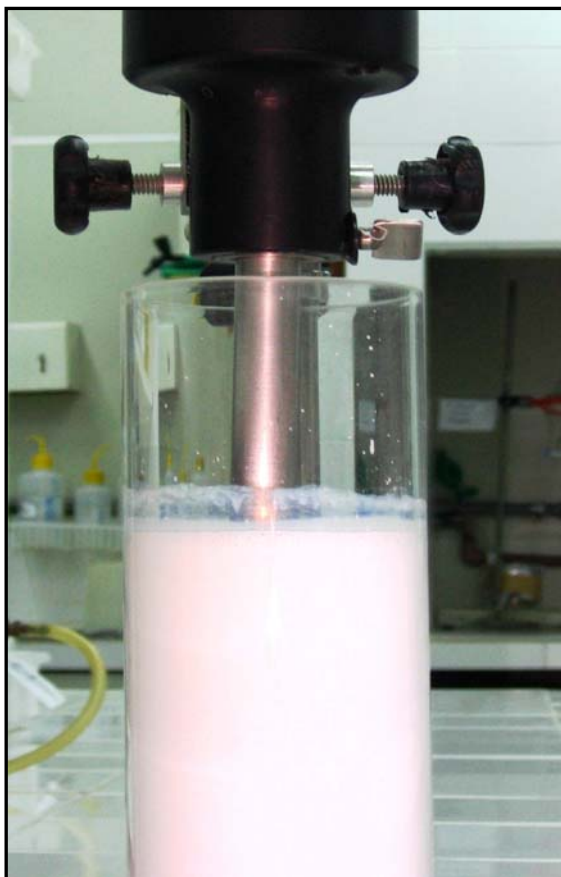
Figura 3.1 - Preparo da miniemulsão no dispersor mecânico (EXTRATUR® Q-252-28).
