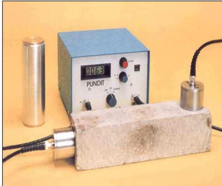
**FIGURA 11 – Aparelho PUNDIT e transdutores.**
