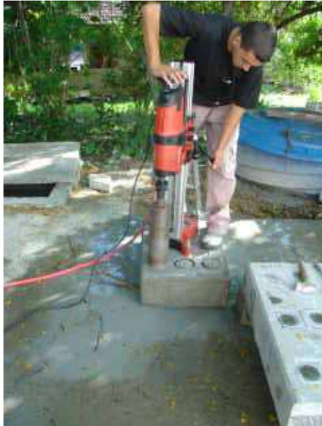
**FIGURA 27 – Extração dos testemunhos das vigas e dos pilares estudados.**
