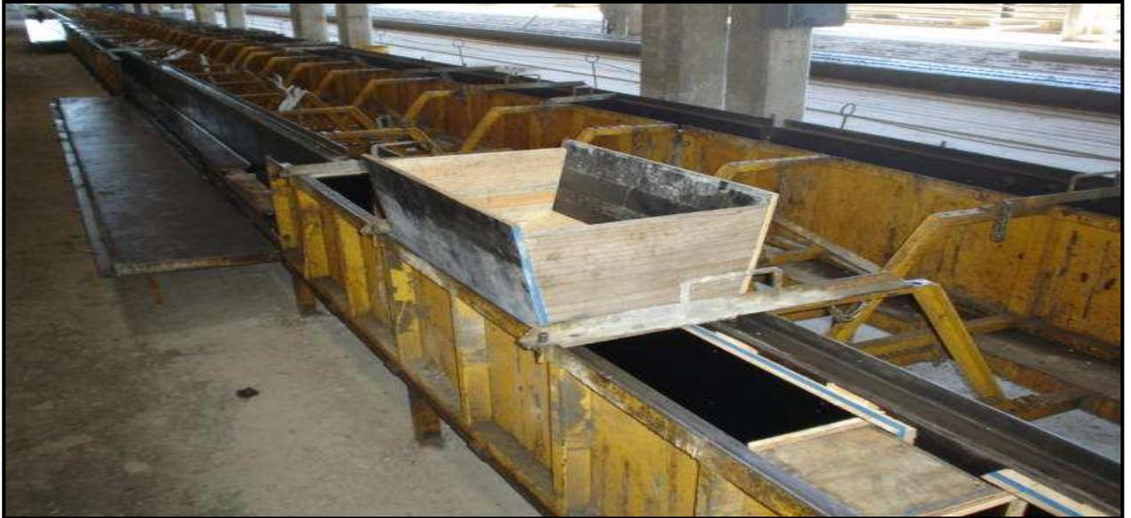
**FIGURA 19 – Formas das vigas que foram utilizadas para a moldagem das vigas estudadas**
