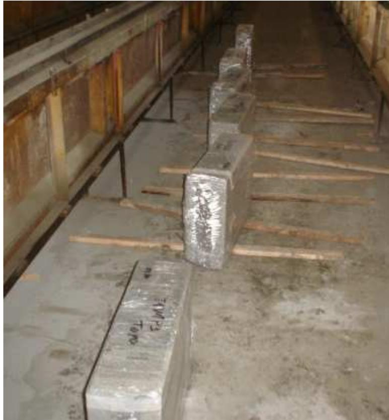
**FIGURA 23 – Vigas traço T1 segmentadas e embaladas com filme plástico para a cura**
