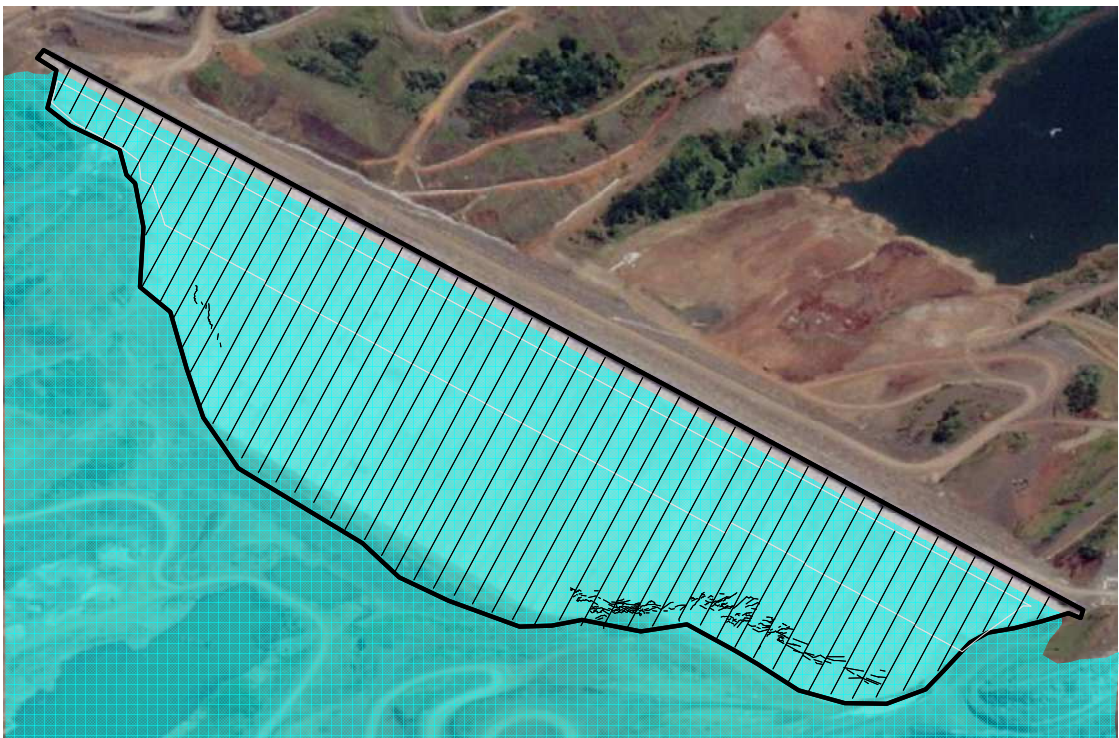
Figura, 3-13 – Mapeamento das trincas obtidas com investigação subaquática.
