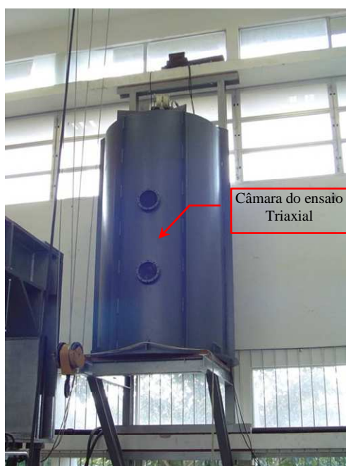
Figura, 6-7 – Câmara do ensaio Triaxial.
