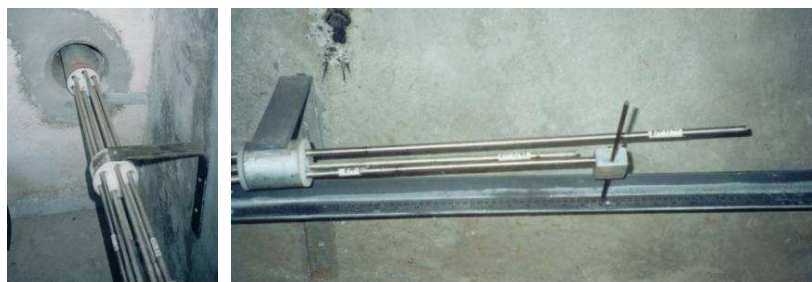
Figura, 4-7 – Extensômetro múltiplo de haste – Leitura do instrumento.
