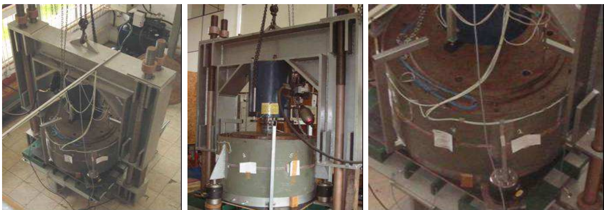
Figura, 6-1 – Equipamento de ensaio Edométrico.
