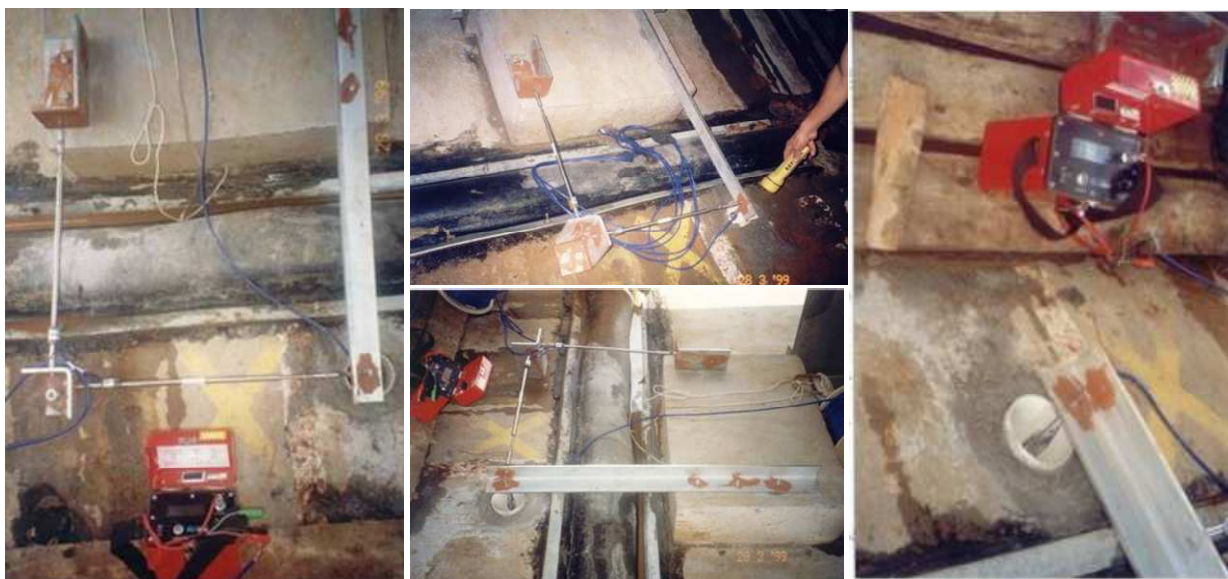
Figura, 4-10 – Medidor de Triortogonal de Junta elétrico.
