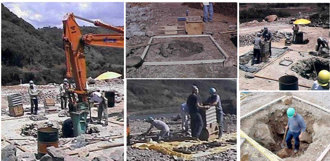
Figura, 3-44 – Controle tecnológico do enrocamento – ensaio granulométrico.
