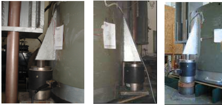
Figura, 6-2 – Detalhe do Equipamento de Ensaio Edométrico.
