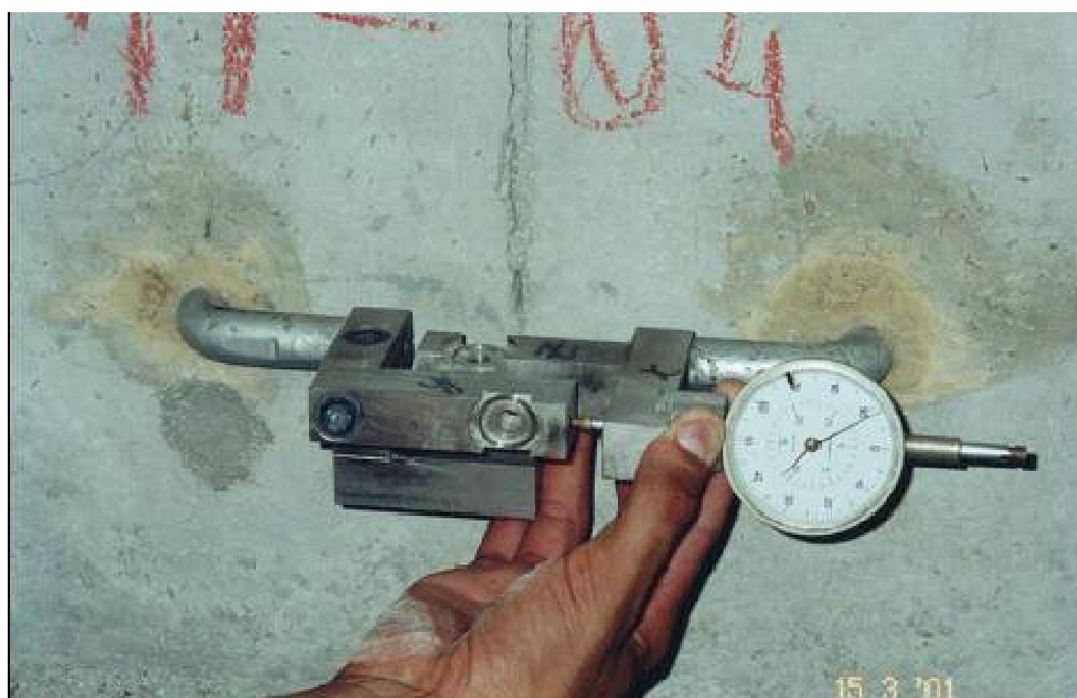
Figura, 4-11 – Medidor Triortogonal de Junta mecânico.
