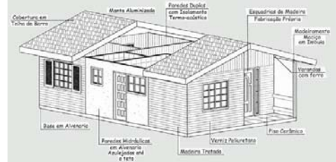
Figura 6.36 Desenho do sistema construtivo da casa da empresa Condor. Site: www.casascondor.com.br . Acesso em 07 de maio de 2007.
