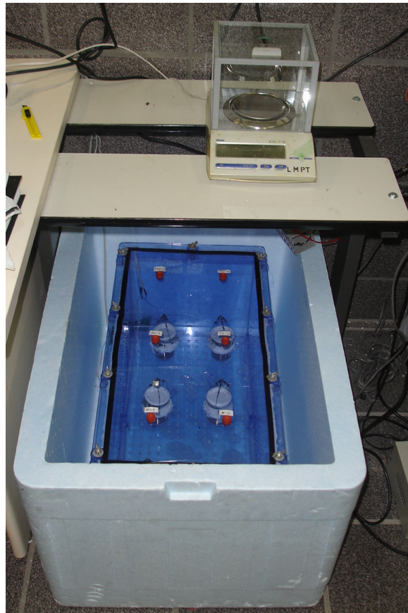
Figura 34 – Experimento de permeabilidade ao vapor montado.
