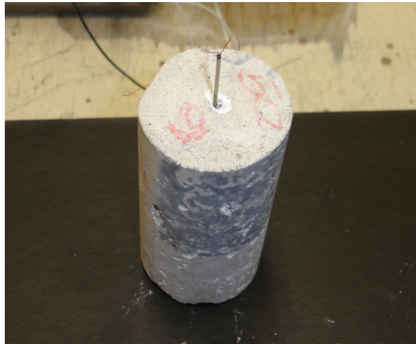
Figura 41 – Conjunto sonda térmica e amostra de argamassa.
