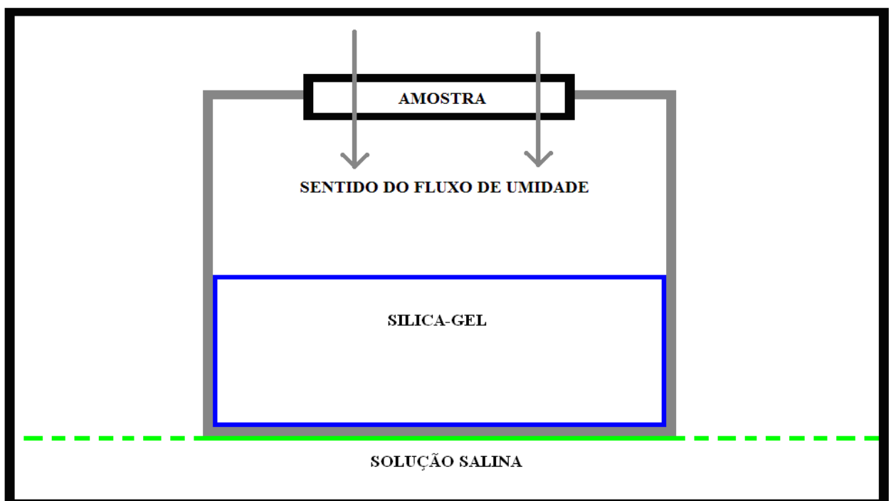
Figura 28 – Esquema do ensaio de permeabilidade ao vapor.
