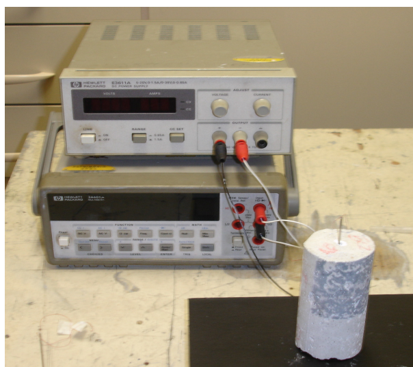
Figura 42 – Aparato experimental da sonda térmica.
