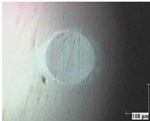
Figura 10 - Desgaste localizado de um apalpador devido ao seu uso em medição por *scanning* [21].
