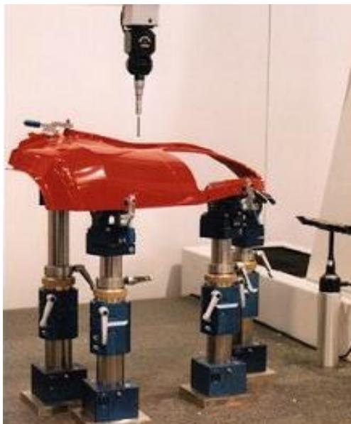
Figura 14 - Sistema de fixação para peças flexíveis <sup>[4]</sup>.
