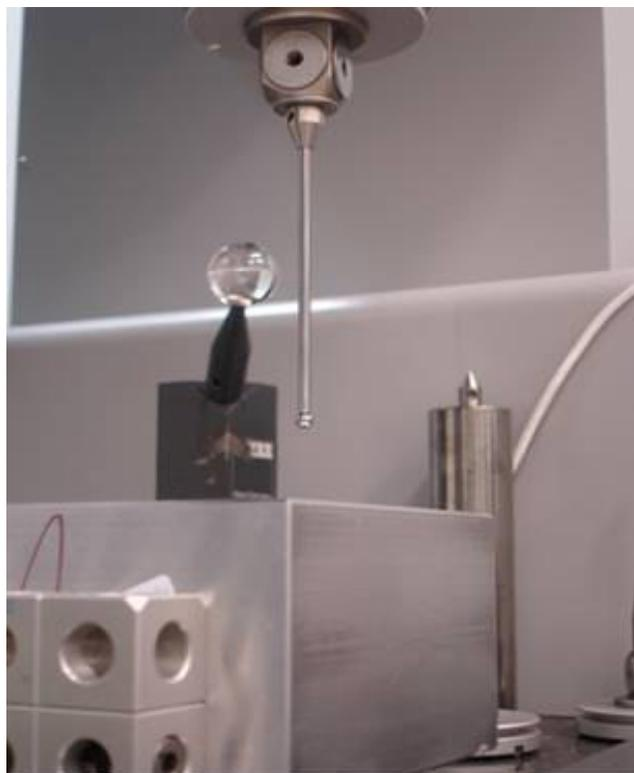
Figura 30 – Foto do sensor instalado na MMC de referência.
