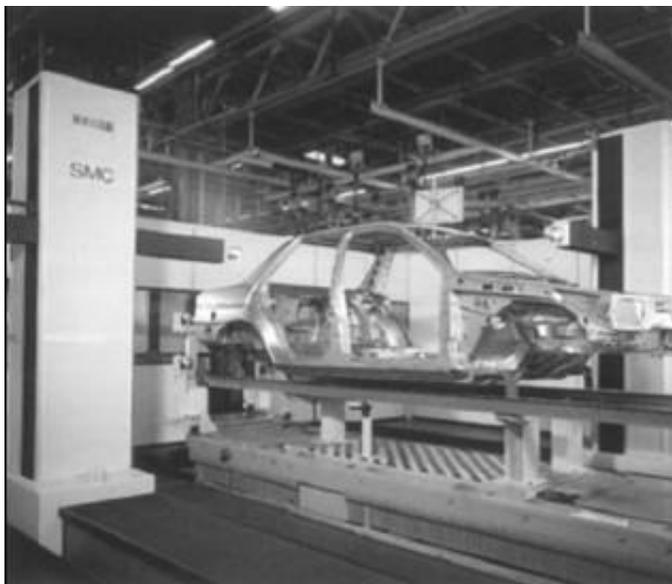
Figura 13 - Inspeção de uma carroceria em MMC <sup>[27]</sup>.
