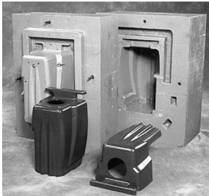
Figura 6 - Molde confeccionado em resina epóxi (VANTICO, 2001).
