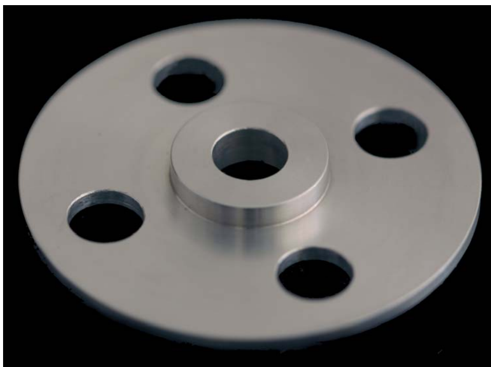
Figura 2 – Matriz de alumínio utilizada para a confecção dos corpos-de-prova
