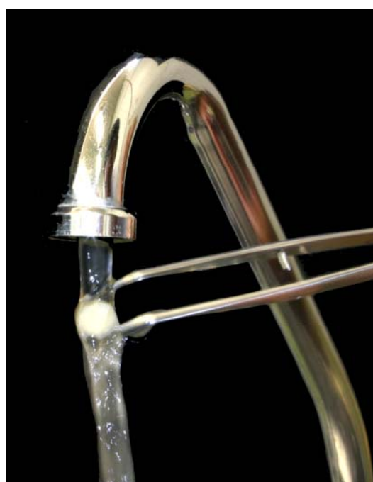
Figura 16 – Limpeza das amostras em água corrente
