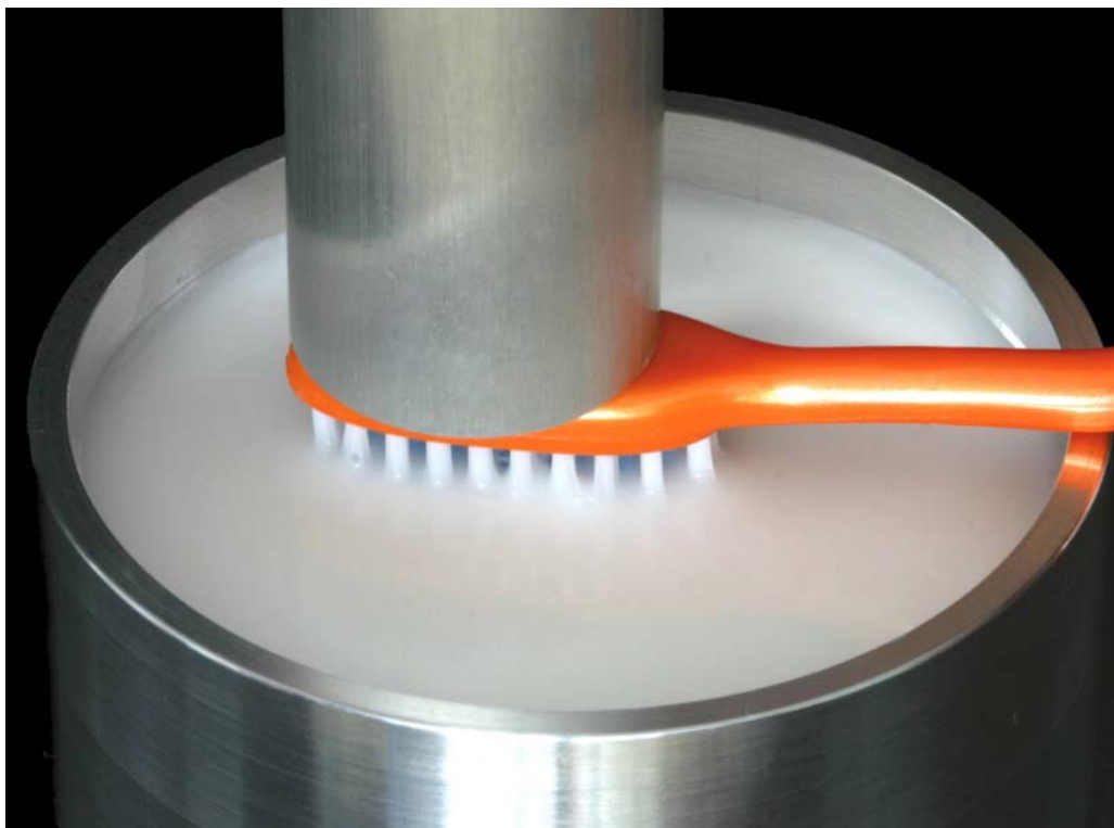
Figura 34 – Solução recém-preparada para ser utilizada durante o teste de escovação
