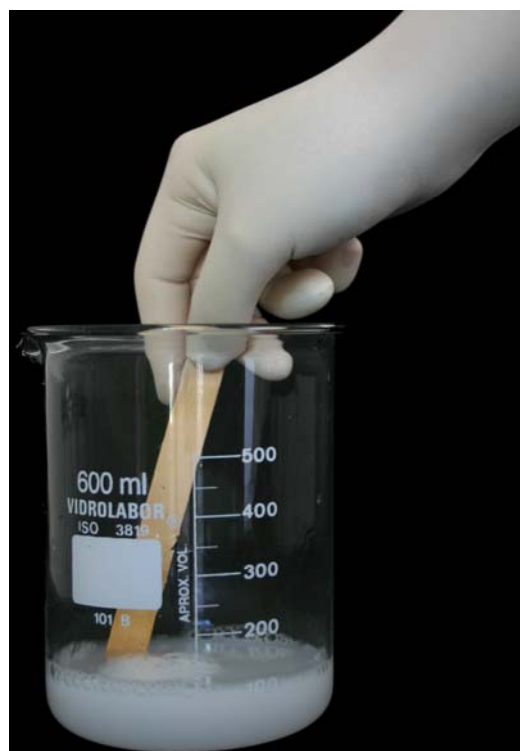
Figura 33 – Preparo da solução para o teste de escovação
