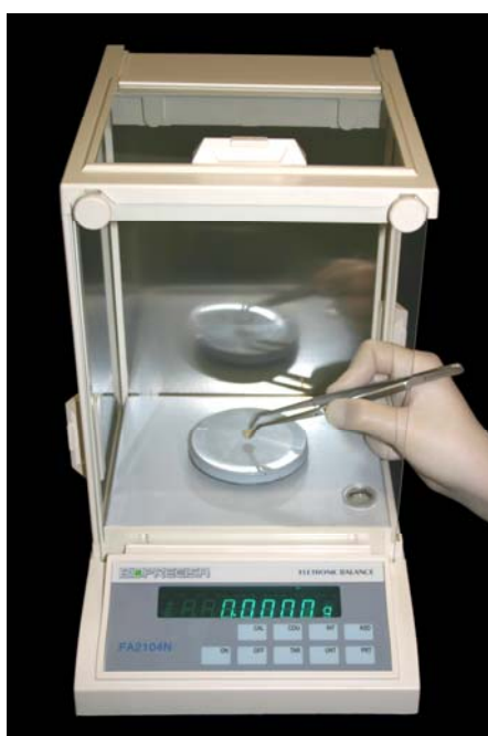
Figura 18 – Posicionamento da amostra na região central do prato da balança
