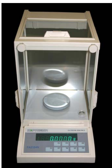
Figura 17 – Balança eletrônica utilizada para a determinação da massa dos corpos-de-prova
