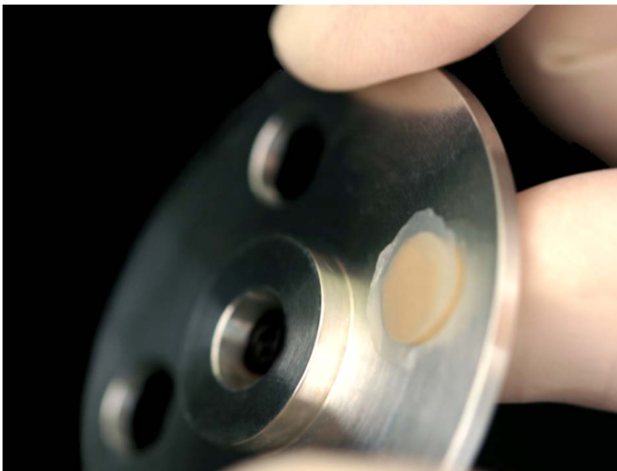
Figura 12 – Remoção do corpo-de-prova da matriz através de pressão digital. Observar que o sentido do movimento de remoção preserva as saliências laterais intactas, evitando a ocorrência de fraturas, trincas, ou ambas, na superfície do corpo-de-prova.
