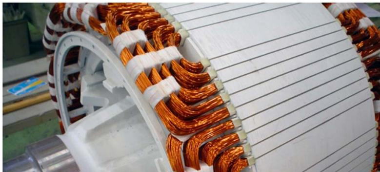
Figura 7.1 - Foto do rotor do BDFIG.
