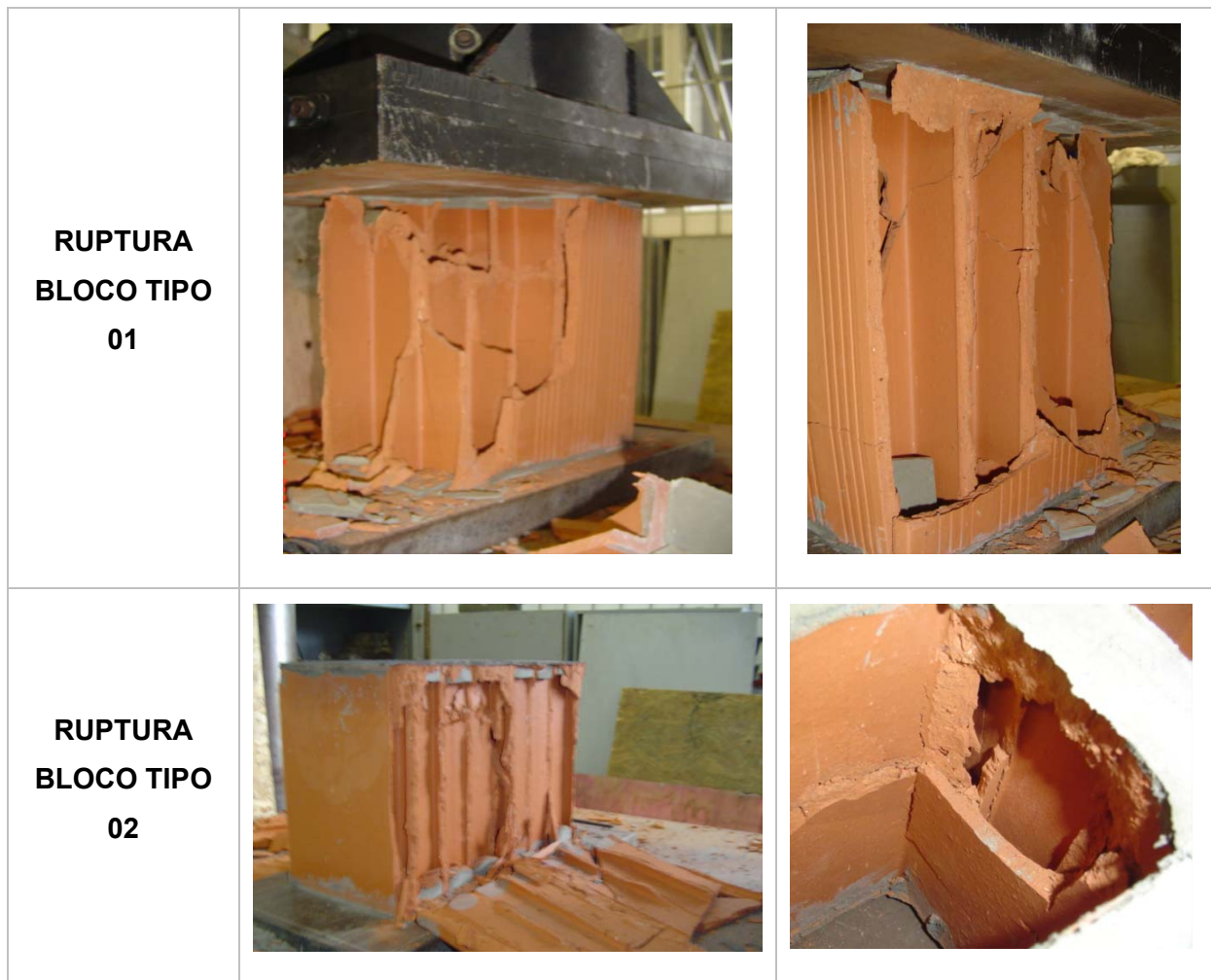
Figura 38 – Forma de ruptura dos blocos tipo B1 e B02.
