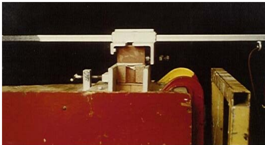
Figura 28 – Aparato para determinação da resistência à tração (ROMAN, 1989)
