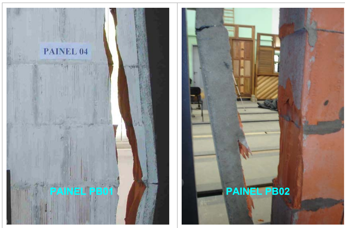
Figura 91 – Interface argamassa armada e alvenaria
