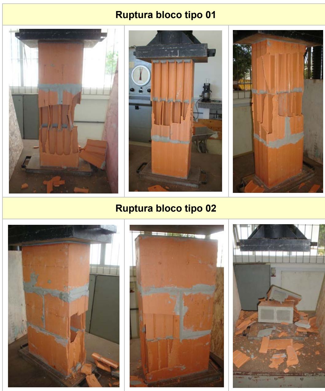
Figura 54 – Modo de ruptura do prisma de junta amarrada de bloco tipo B01 e B02
