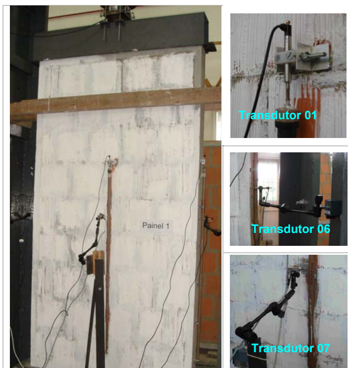
Figura 74 – Visão geral da instrumentação
