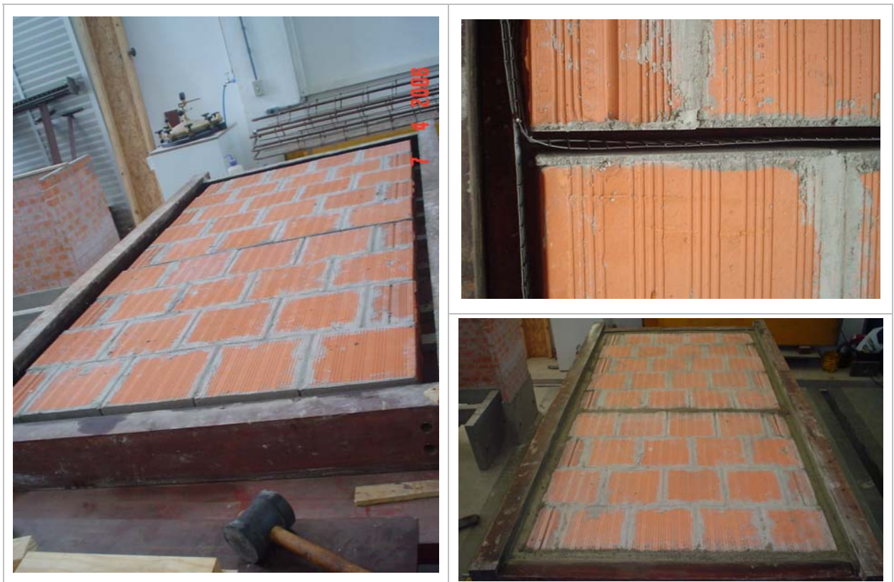
Figura 92 – Moldagem painel com junta armada no centro.
