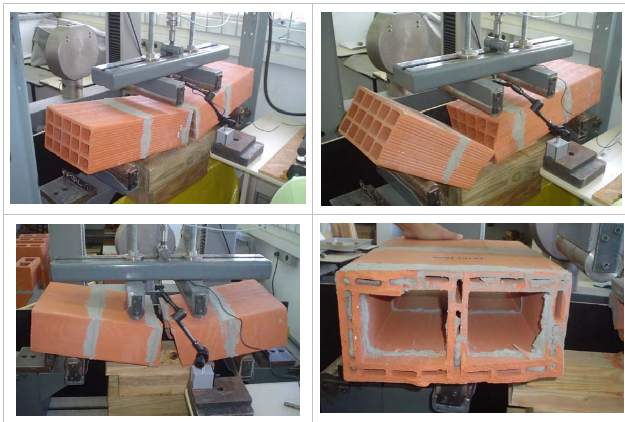
Figura 98 – Formas de ruptura apresentadas pelos prismas de blocos B01 e B02.
