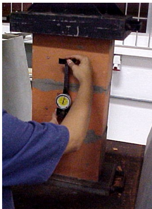
Figura 56 – Forma de leitura das deformações com extensômetro mecânico
