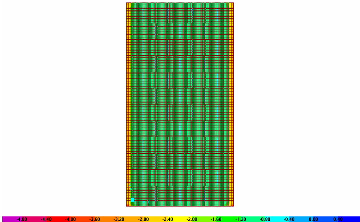
Figura 112 – Distribuição de tensões \sigma_z ao longo do plano (x, z) do painel PB02 (vista frontal)
