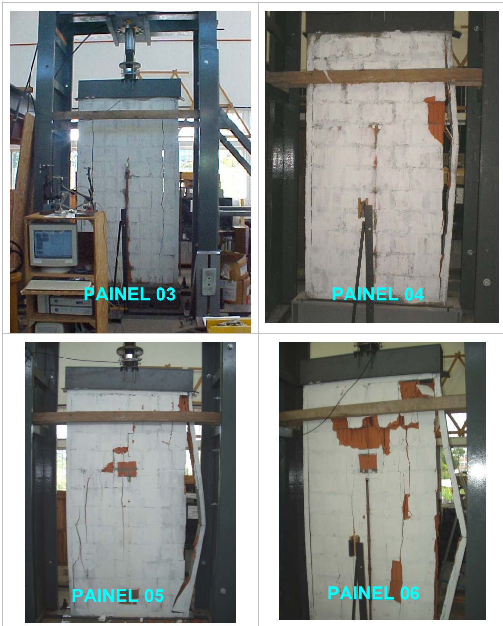
Figura 90 – Forma de ruptura dos painéis PB02
