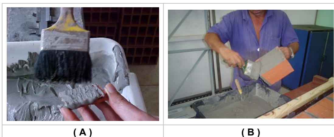
Figura 41 – Forma de aplicação da argamassa polimérica no corpo-de-prova
