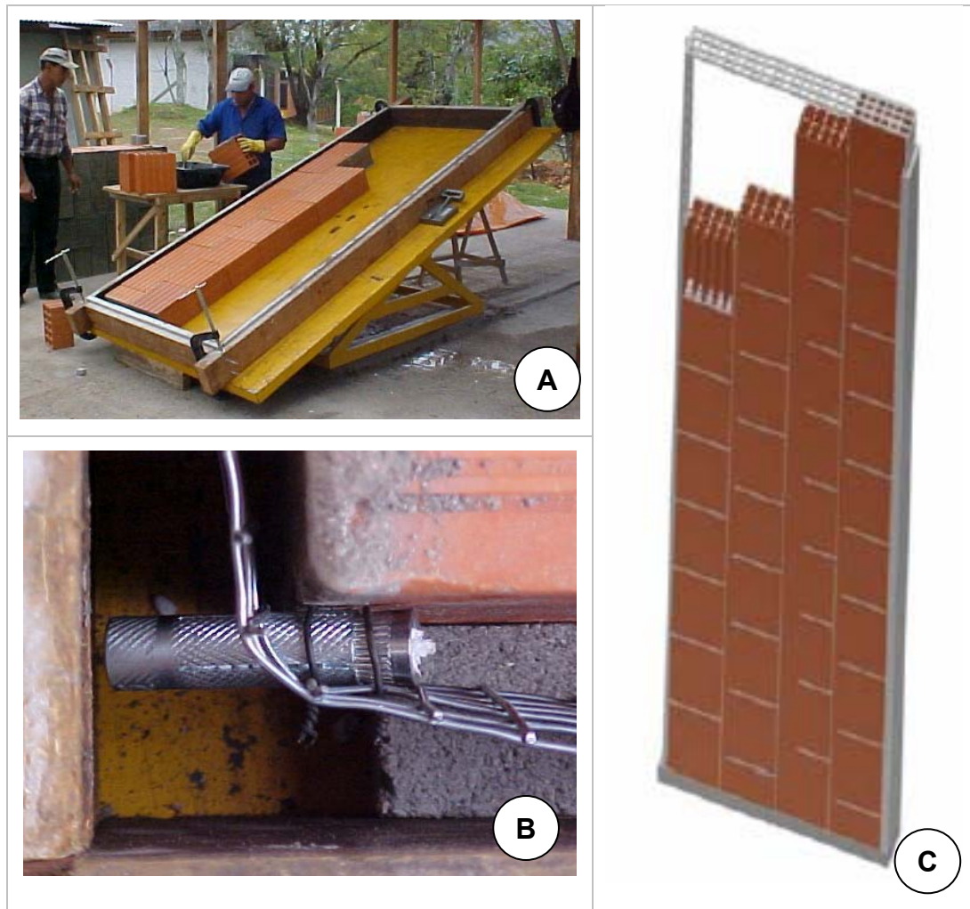
Figura 20 – (A) Moldagem do painel, (B) Detalhamento da tela metálica junto com o inserte e (C) Tipologia final do painel (BARTH E CARDOSO, 2003)
