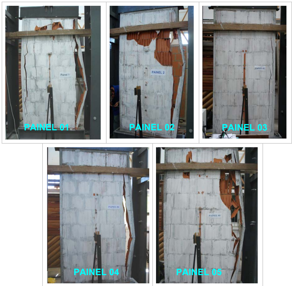
Figura 89 – Forma de ruptura dos painéis PB01
