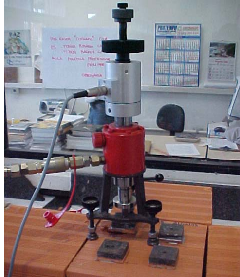
Figura 42 – Equipamento utilizado para determinar a carga máxima de ruptura.
