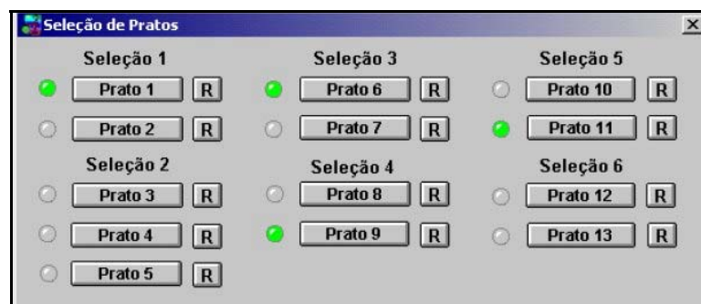
Figura 3.10 Seleção das resistências para cada prato no controle distribuído.
