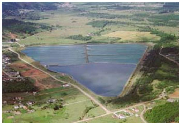
**Figura 6:** Lagoas de Estabilização. Sistema de tratamento de esgotos da Lagoa de Conceição – Florianópolis
