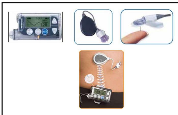
Figura 6: Equipamento *MiniMed Paradigm Real-Time*, composto por uma bomba de infusão de insulina e sensor de glicose, possibilitando a transmissão dos dados por infravermelho.
