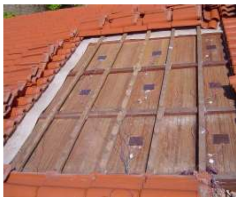
Ilustração 17 – Vista geral da localização dos transdutores e termopares
