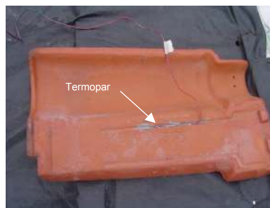
Ilustração 16 – Termopar na face inferior da telha
