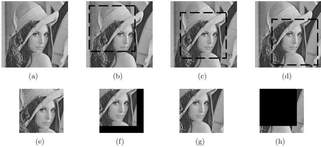
Figura 2.1: Exemplo da dinâmica do sinal (ver Eq.(2.3)), considerando movimento translacional da câmera e iluminação constante. (a) Cena original. (b)-(d) Imagens nos instantes de tempo t - 2 até t (imagem HR \mathbf{x}(t - l) , l = 0, 1, 2 ). Representações matriciais de: (e) \mathbf{x}(t - 1) ; (f) \mathbf{G}(t)\mathbf{x}(t - 1) ; (g) \mathbf{x}(t) ; (h) \mathbf{s}(t) = \mathbf{x}(t) - \mathbf{G}(t)\mathbf{x}(t - 1) (inovações).
