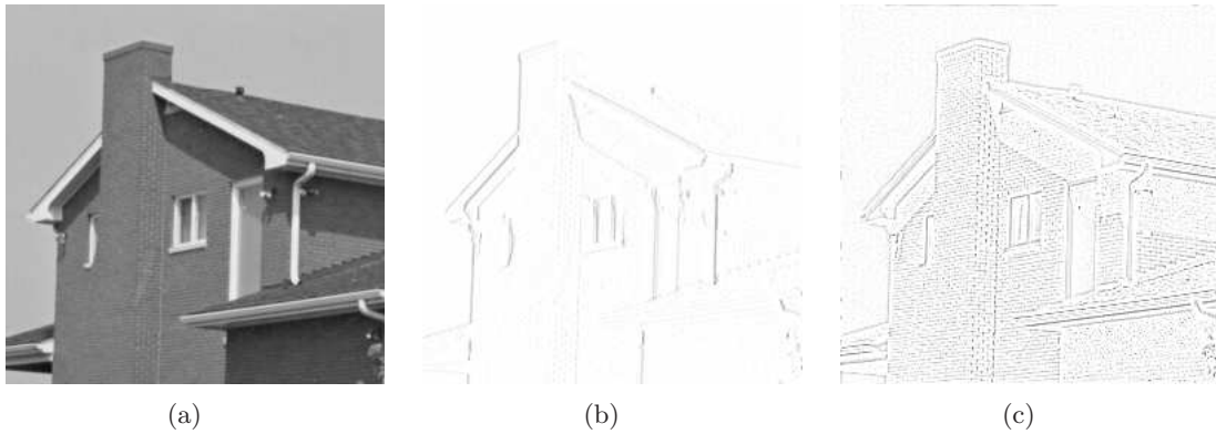
Figura 5.1: Efeito passa-altas causado pelos erros de registro. (a) Imagem house . (b) Efeito de uma realização. (c) Efeito de 100 realizações.
