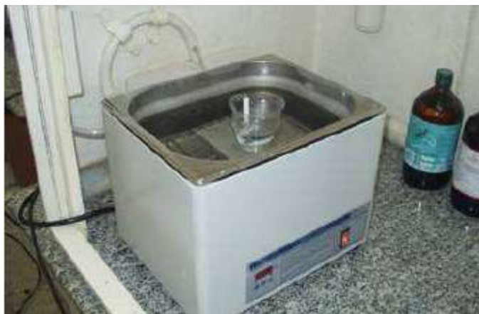
Figura II.1.2: Processo de oxidação, o silício é colocado por 1 h a 82°C em uma solução contendo 100 ml de H 2 O DD, 20 ml de H 2 O 2 e 20 ml de amônia.
