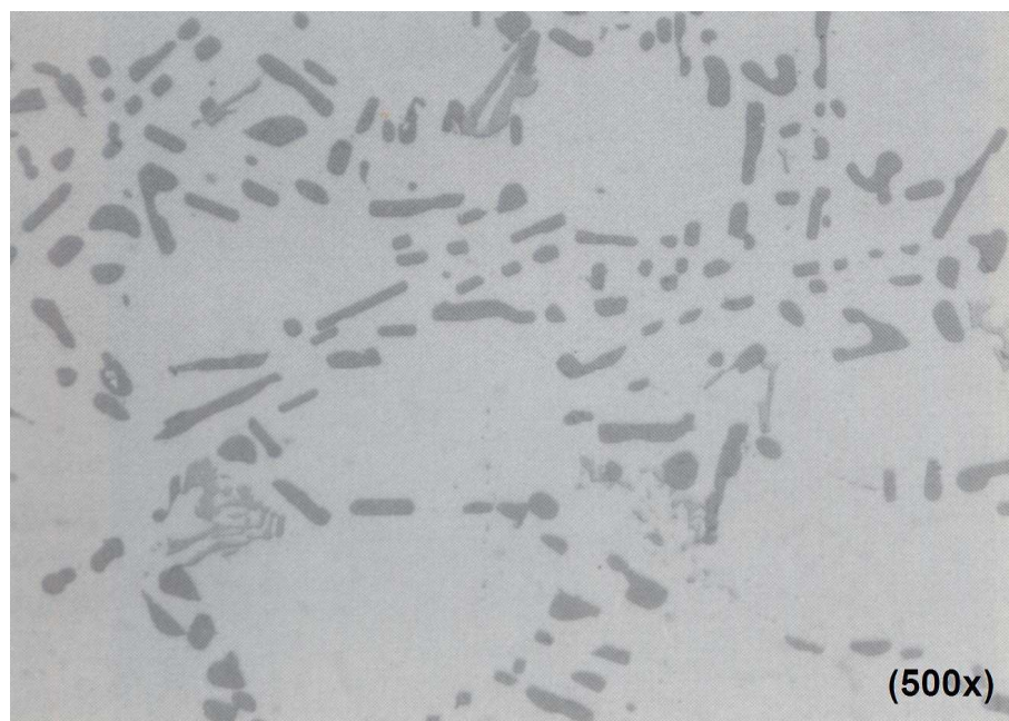
Figura 2.37: Partículas de Si esferoidizadas após o aquecimento durante 8 h a 540 °C (APELIAN; SHIVKUMAR; SIGWORTH, 1989).
