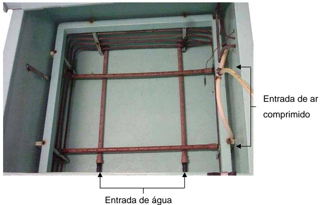
Figura 3: Vista superior do tanque de imersão, detalhe das tubulações para distribuição de ar comprimido e de água.
