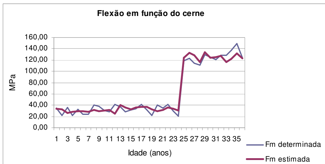
Figura 41 - Comportamento da flexão em função do cerne
