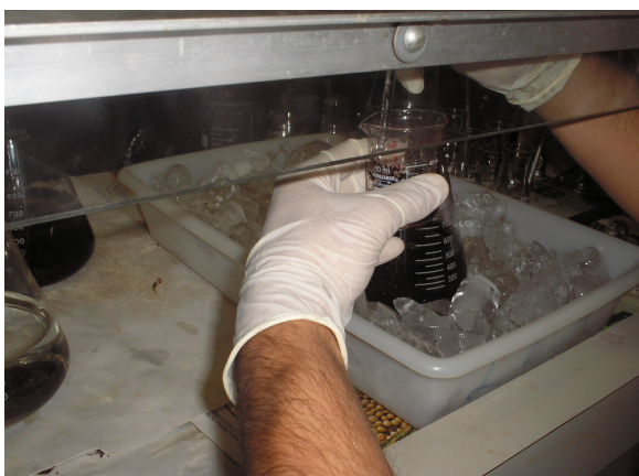
Figura 67 – Tratamento com ácido sulfúrico a temperatura de (15 \pm 2) °C.
