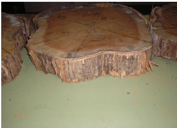
Figura 63 - Discos preparados para retirada de amostras de serragem para determinação de lignina.
