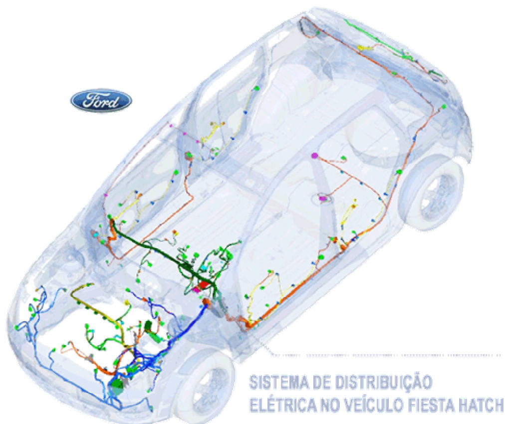
Figura 3 – Sistema de distribuição elétrica no veículo Fiesta Hatch
