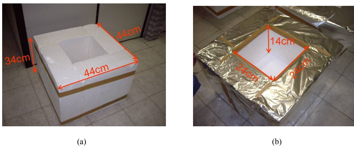
Figura 20 – (a) Dimensões externas do calorímetro em fase de execução. (b) Dimensões internas do calorímetro concluído.
