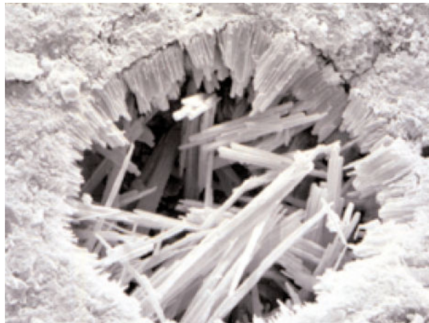
Figura 5 – Etringita secundária localizada no poro de uma pasta de cimento Portland ( http://www.ctu.edu.vn/colleges/tech/bomon/ktdx )
