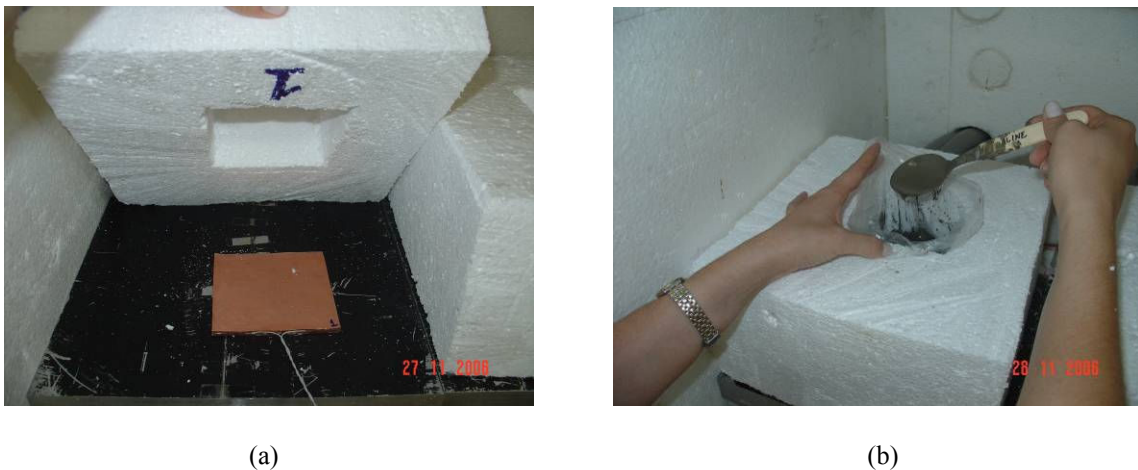
Figura 25 – Detalhe interior do calorímetro isotérmico. (a) Posicionamento do transdutor sobre o trocador de calor aderido por uma fina camada de gel. (b) Preparo da amostra sobre o transdutor, envolvidos pelo cubo vazado de EPS, com aquisição de dados instantânea.
