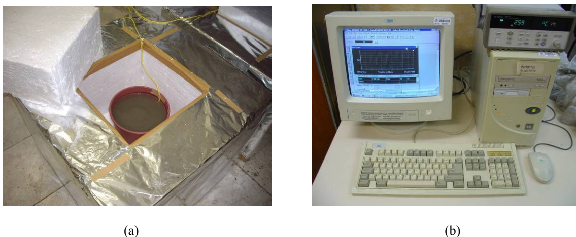
Figura 22 – (a) Representação do sistema de isolamento térmico para medição do aumento de temperatura. (b) Sistema de aquisição de dados.
