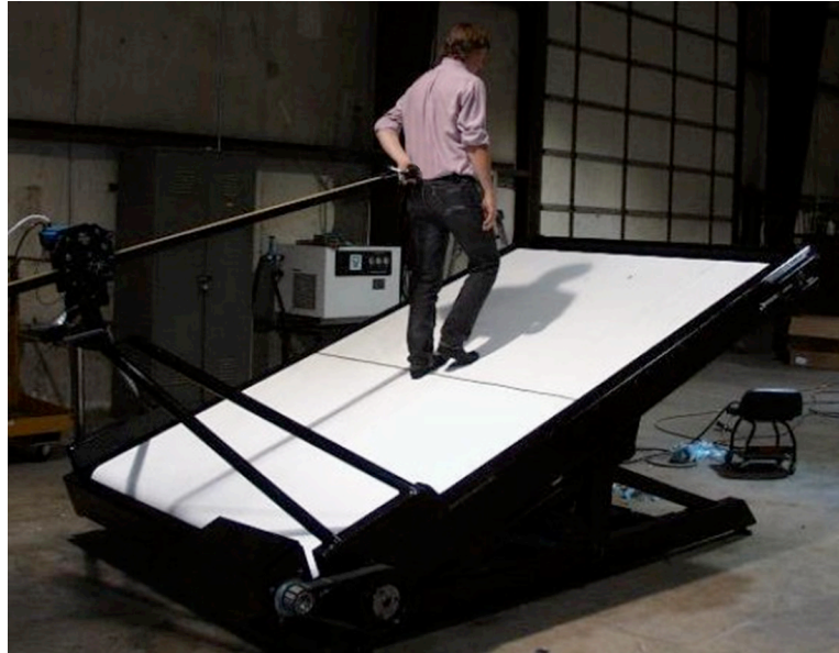
Figura 19: Segunda geração do Treadport 21 .
