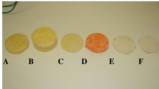
Figura 1.1 - Foto demonstrando os materiais utilizados. O tipo do material é dado pela letra logo abaixo do mesmo. Os materiais A, B, C e D são compostos por fibras de vidro e os materiais E e F são feltros. Suas espessuras aproximadas são, respectivamente, de 26, 44, 11, 11, 6 e 3 mm.
