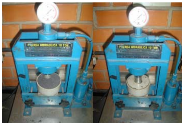
Figura 5.4 – foto da bancada em duas situações, uma com o porta-amostra com amostra (esquerda). E outra foto (direita) sendo que a amostra está comprimida dentro do porta-amostra pelo cilindro de compressão.
