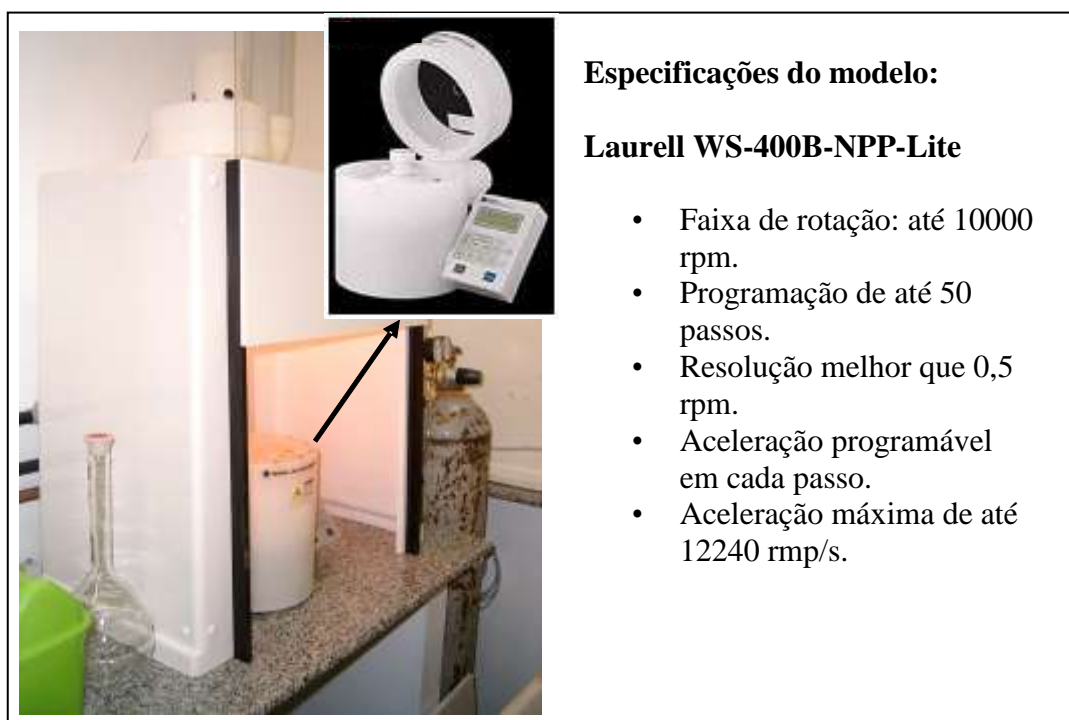
Fig. 2.11: Spin-coater usado no trabalho e suas especificações.
