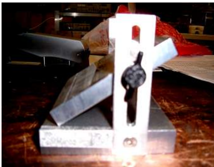
Fig. 2.7: Dispositivo de inclinação com ângulo variável utilizado na preparação de cristais coloidais via sedimentação inclinada.
