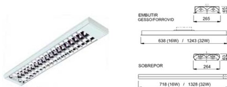
Figura 2.18 – Luminária direta com aletas mod. C 2336 Fonte: LUSTRES PROJETO, 2003.
