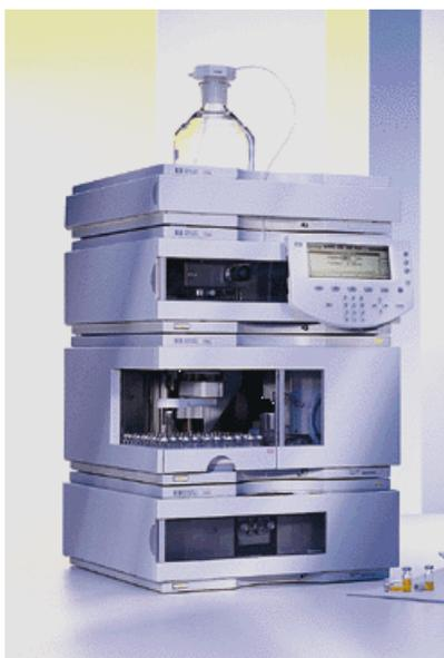
**Figura 5.8** – Equipamento para realizar a CLAE.
