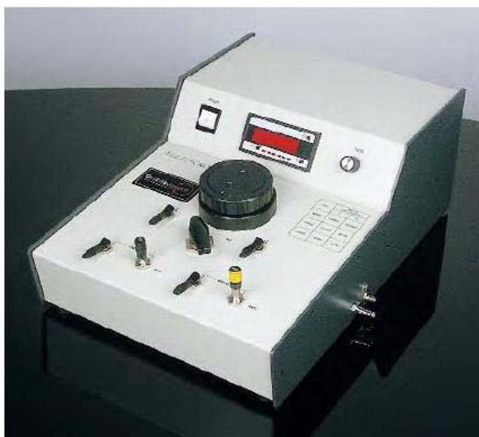
**Figura 5.7** -O Multipicnômetro utilizado da marca Quantachrome.
