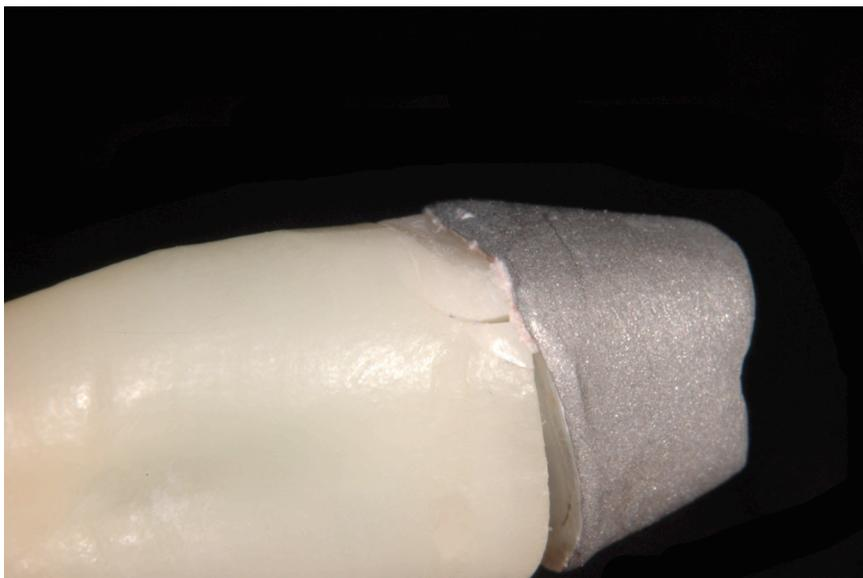
Figura 18: Espécime do G1 com deslocamento do *coping*/núcleo metálico e fratura radicular.
