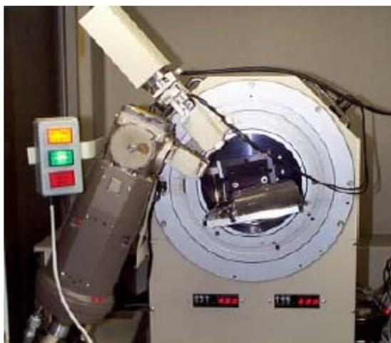
Figura 7 – Exemplo prático de uma Fonte de raios-X, executando o ensaio em uma amostra [8].
