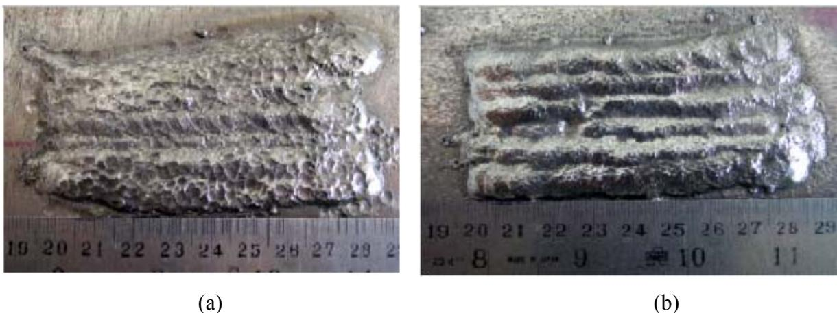
Figura 37 – Superfícies marteladas; (a) com punção (b) com agulhas.
