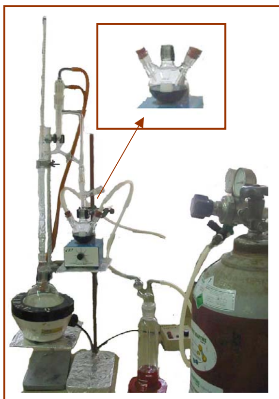
Figura 9. Sistema montado para síntese do ânion radical naftaleno, utilizando como álcali o sódio.
