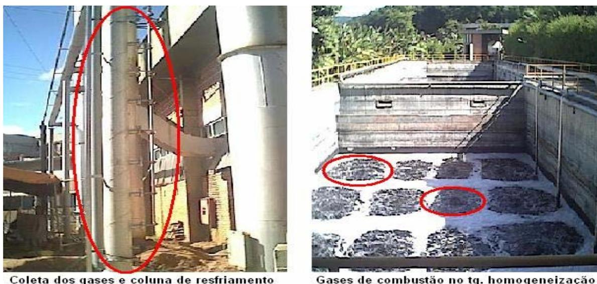
Figura 5.28 – Sistema de neutralização de efluente por gases de combustão
