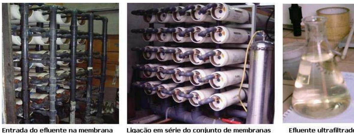
Figura 5.173 – Conjunto de membranas de ultrafiltração do STET da IEB-03.
