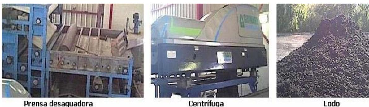
Figura 5.102 – Imagens do processo de desidratação da IPM - 05
