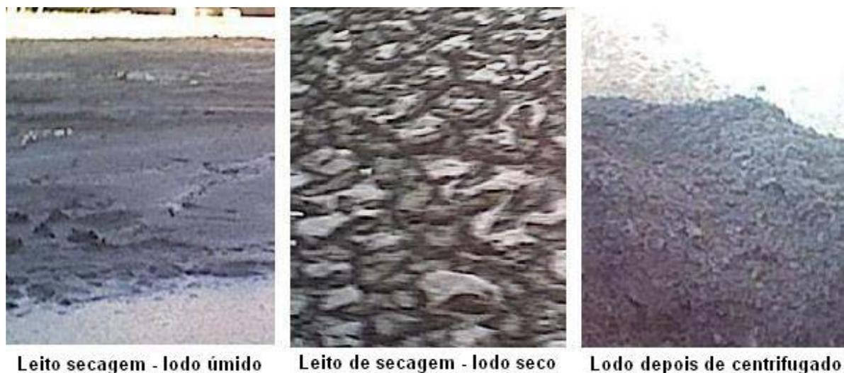
Figura 5.10 – Comparação - lodo de leito de secagem e o centrifugado - IBA-02
