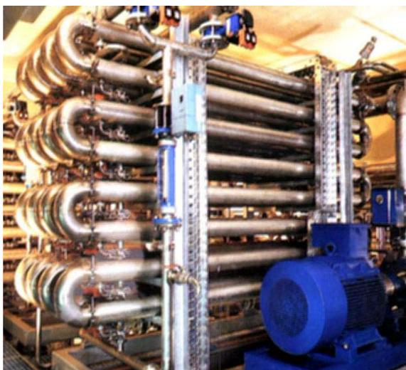
Figura 2.48 – Unidade de Ultrafiltração
