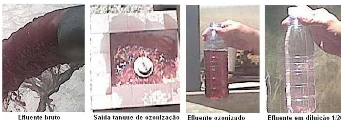
Figura 5.89 – Efeito da ozonização na remoção de cor na IPM-02.
