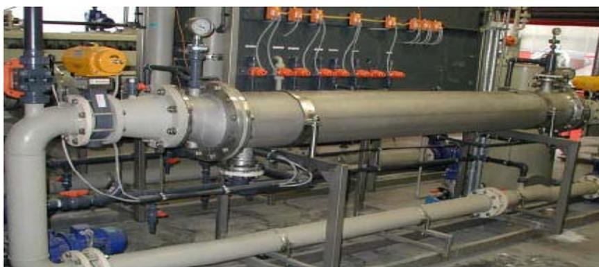
Figura 2.55 – Membrana de microfiltração – recuperação água e pasta.
