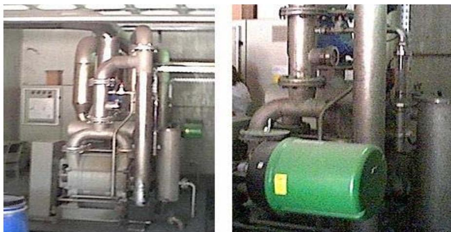
Figura 5.127 – Equip. de neutralização por gases de combustão – IPM-10
