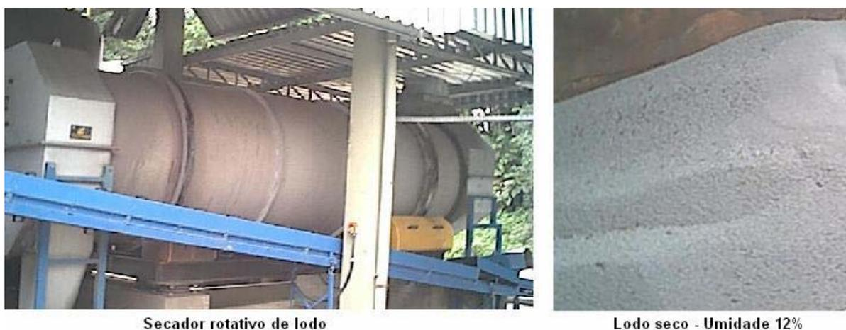
Figura 5.56 – Secador rotativo de lodo e amostra de lodo seco.
