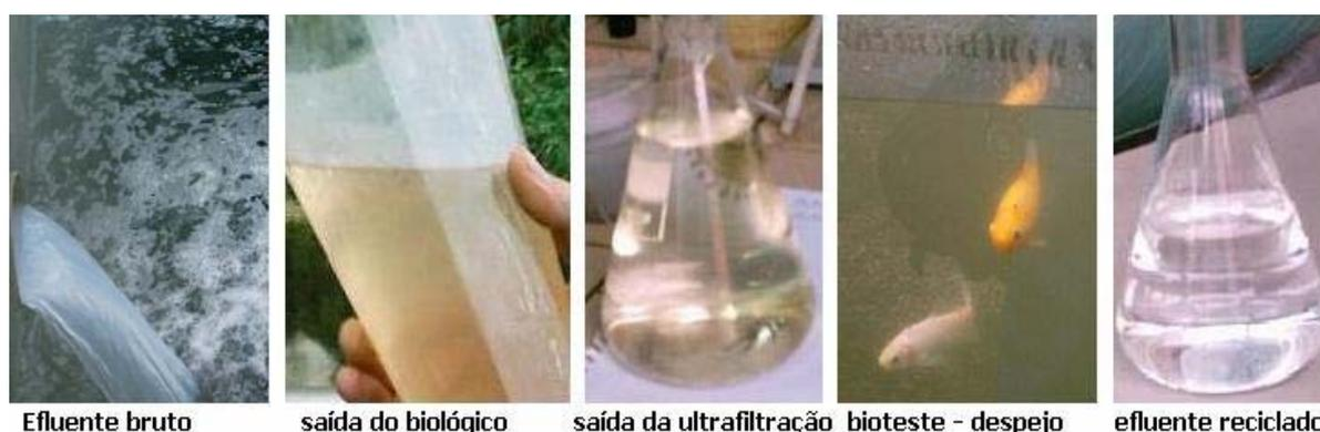
Figura 5.175 – Comparação visual entre os efluentes no STET da IEB-03.
