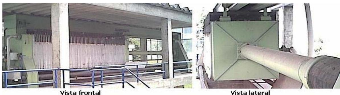
Figura 5.142 – Filtro prensa desativado na IPM - 14
