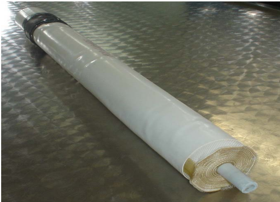
Figura 9. Membrana orgânica de polissulfona de configuração espiral (Romicon ® ) utilizada nos experimentos. Fonte: Foto do autor.
