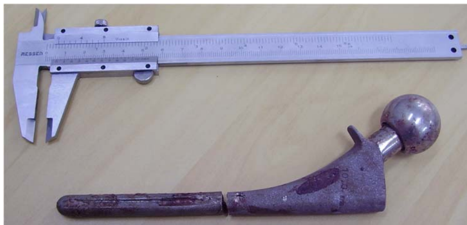
Figura 1.1: Falha característica de hastes femorais fixadas sem cimento. O componente esteve implantado por 6 anos. Cortesia: Dr. Abel do Rosário - Laboratório de Engenharia Biomecânica do Hospital Universitário da UFSC.
