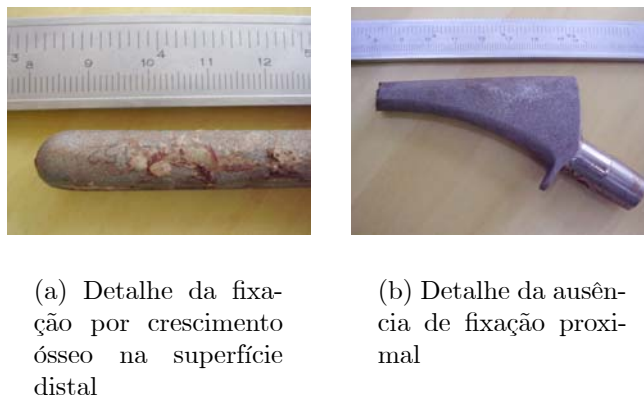
Figura 1.2: Aparência da superfície nas porções proximal e distal da haste fraturada. Cortesia: Dr. Abel do Rosário - Laboratório de Engenharia Biomecânica do Hospital Universitário da UFSC.
