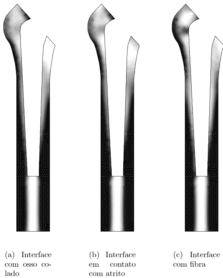
Figura 5.19: Resultados da adaptação óssea para casos de carga levemente alterados.
