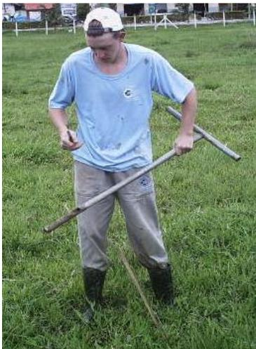
**Anexo E: Penetrômetro utilizado para avaliar a resistência a penetração.**
