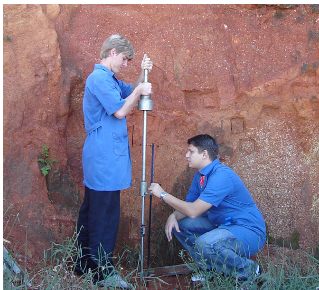
FIGURA 09. Execução do ensaio de DCP em campo.
