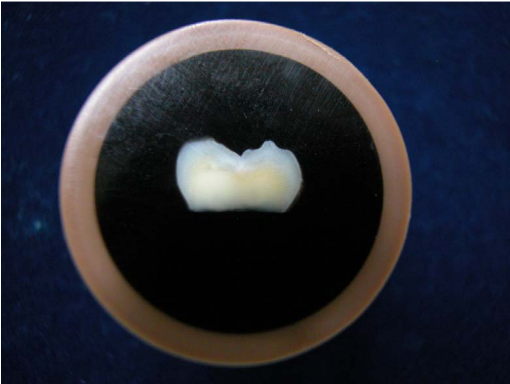
Figura 14 – Corpo de prova pronto para a confecção e fixação adesiva do cilindro de resina
