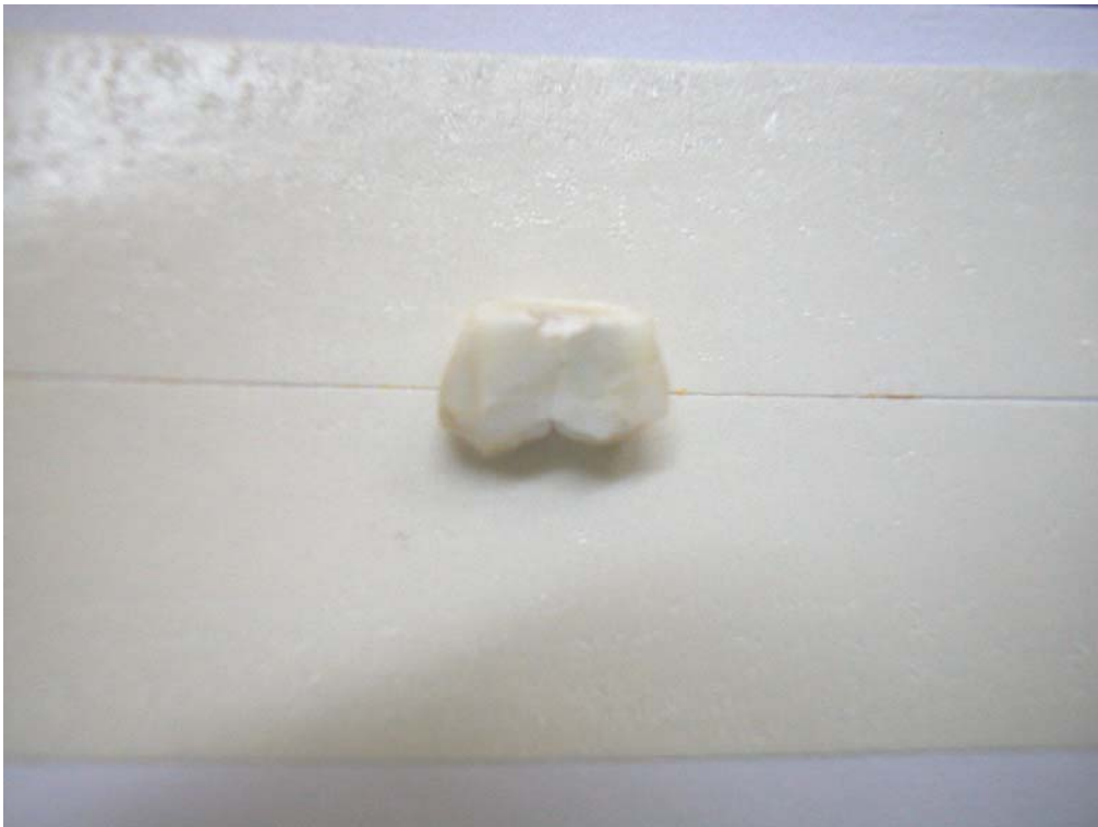
Figura 10 – Espécime posicionado sobre a fita dupla face
