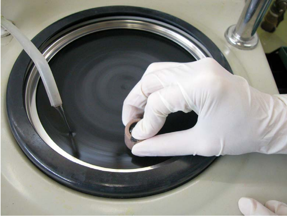
Figura 13 – Desgaste do esmalte na politriz
