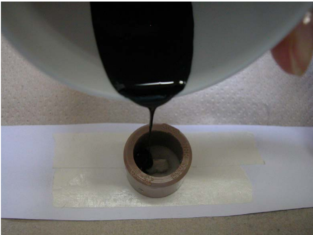
Figura 12 – Preenchimento do anel com resina epóxica
