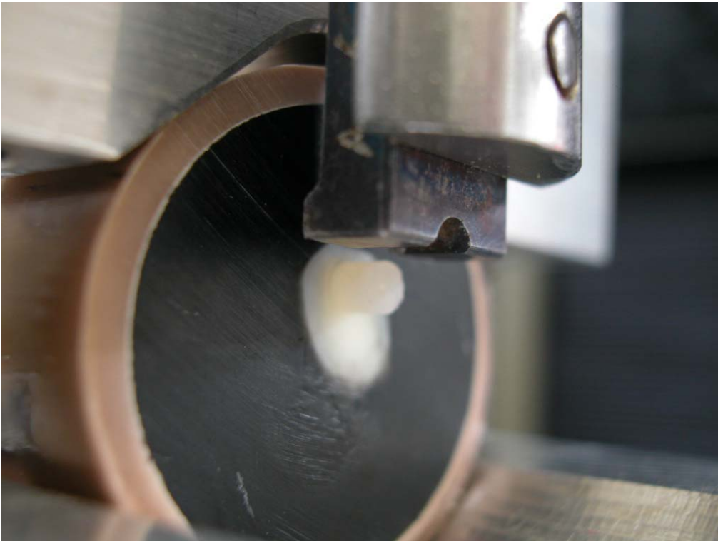
Figura 1 – Cilindro de resina unido perpendicularmente à superfície dentinária e uma vista aproximada da lâmina em posição para o teste de cisalhamento
