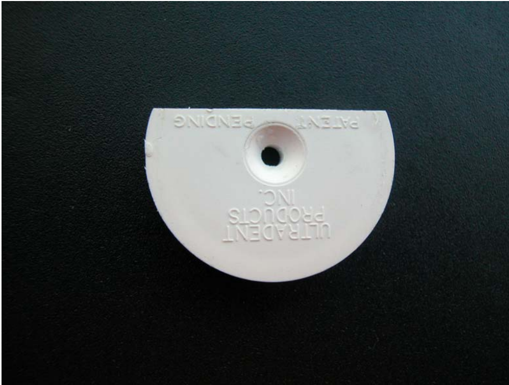
Figura 15 – Matriz de teflon utilizada para a confecção do cilindro de resina composta. Observar orifício central, onde será inserida a resina composta
