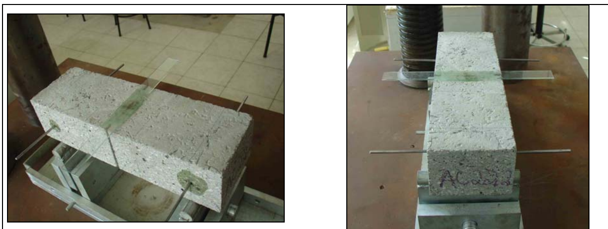
Figura 51 : Vigas preparadas para o ensaio.
