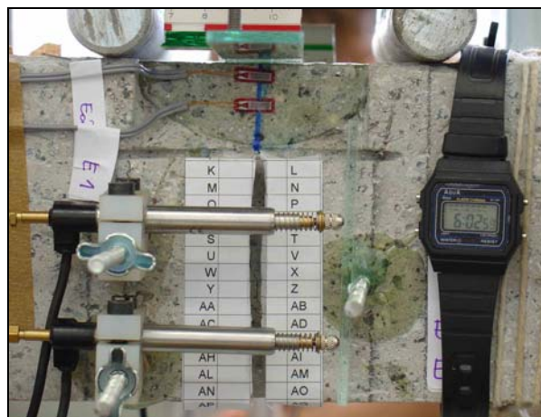
Figura 55 : Posicionamento dos transdutores de deslocamento nas laterais da viga para medição da abertura de fissuras.
