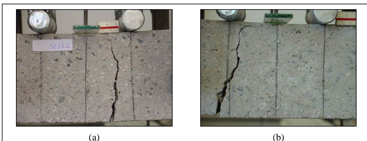
Figura 58 : Casos em que a fissura não ocorre no centro do vão: (a) dentro do terço médio central e (b) fora do terço médio central.
